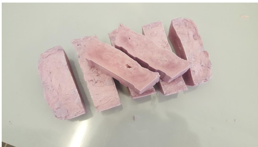
Slika 10. Sapun RS1 s neotopljenim sapunom S1
