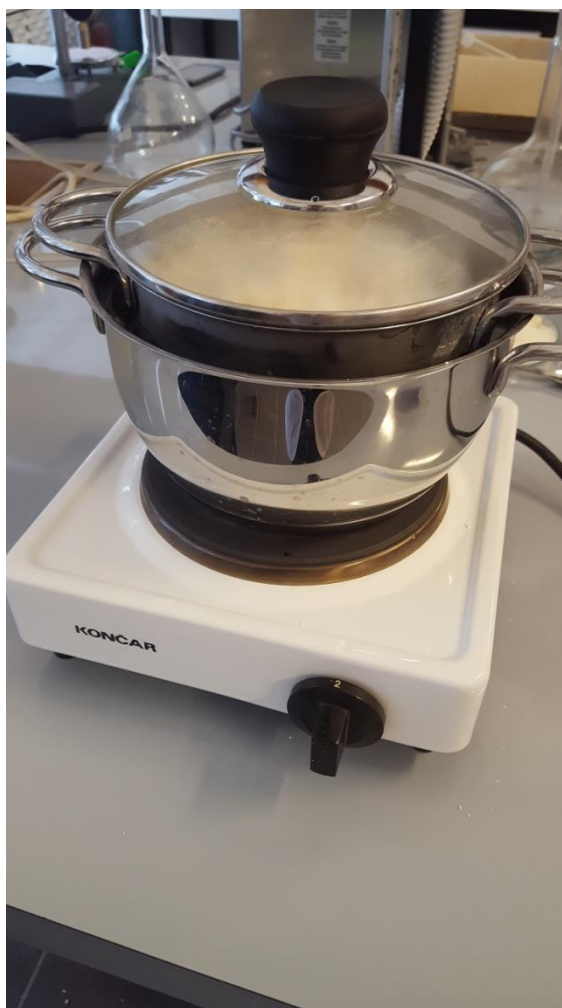
Slika 7. Zagrijavanje sapuna na vodenoj kupelji
