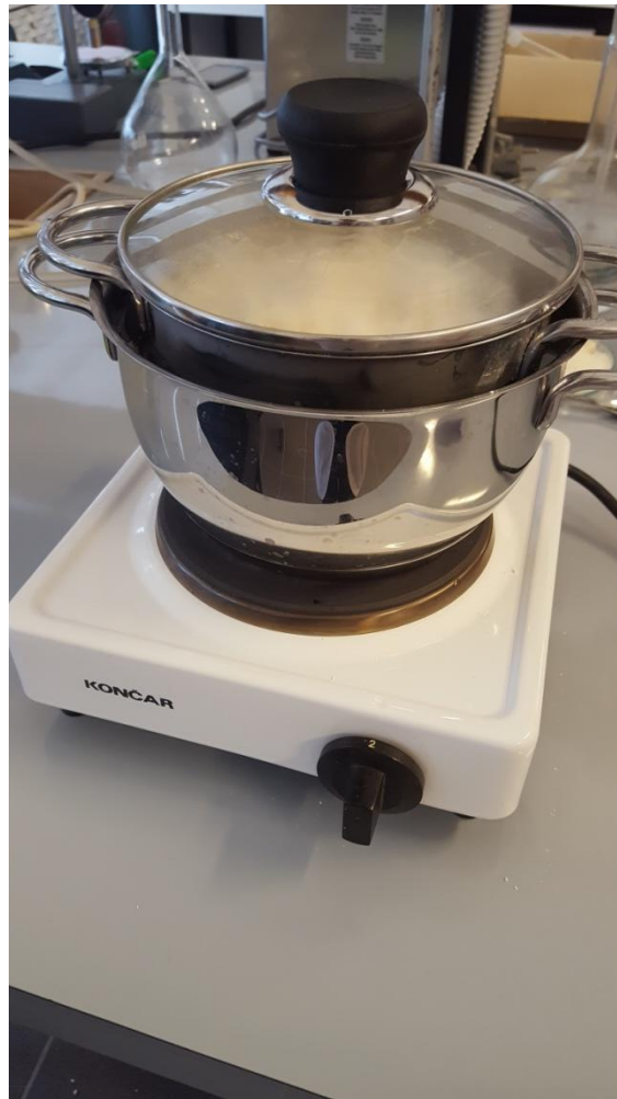
Slika 7. Zagrijavanje sapuna na vodenoj kupelji
