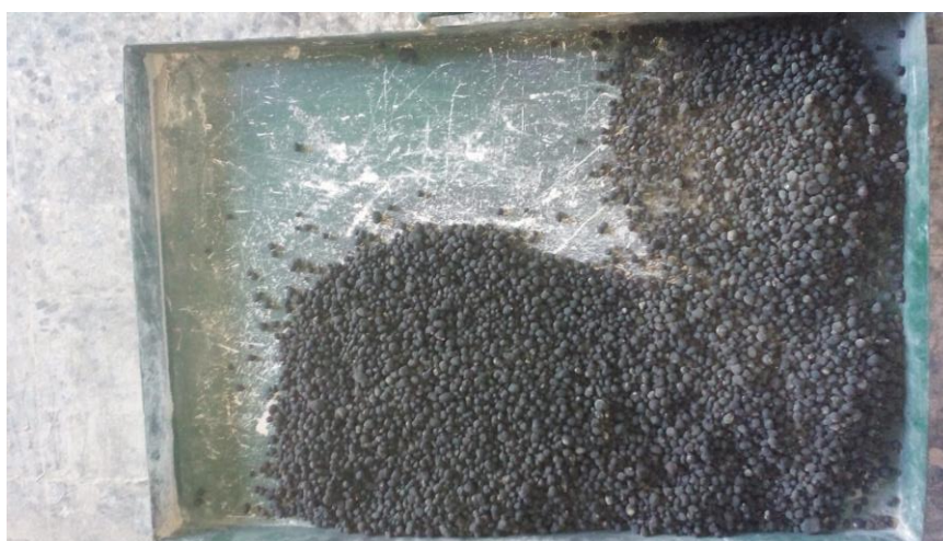
Slika 21. Dobiveni klinker uslijed pečenja na poluindustrijskoj peći
