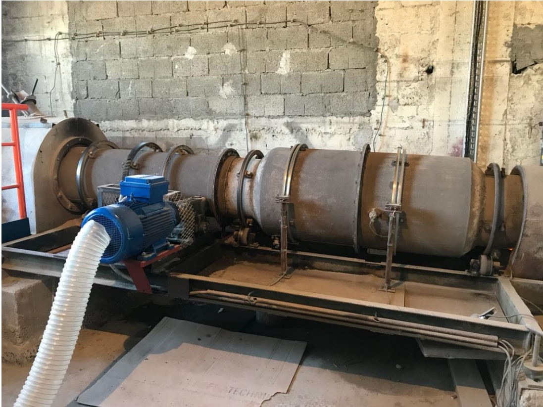
Slika 27. Rotacijska peć poluindustrijske izvedbe
