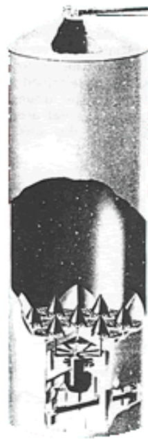
Slika 8. Konstrukcija silosa kontinuiranog protoka (CF) [7]
