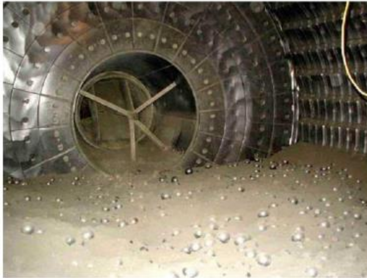
Slika 18. Unutrašnjost mlina s kuglama za mljevenje klinkera [5]
