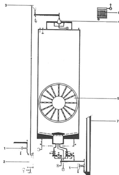
**Slika 7.** Shema protočnog silosa kontinuirane homogenizacije [7]
