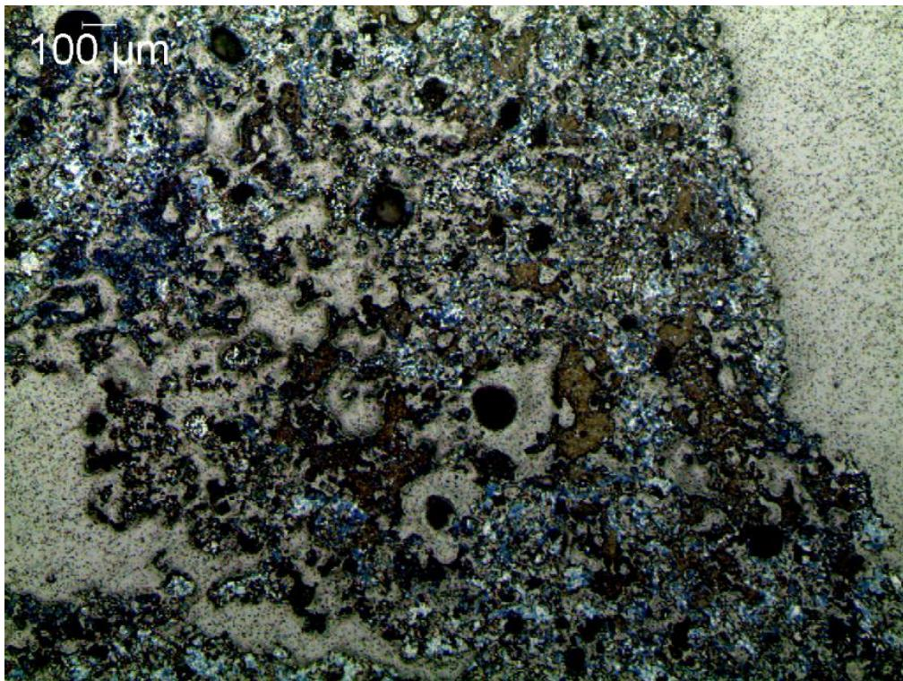
**Slika 28.** Uzorci klinkera snimljeni pri povećanju od 5x
