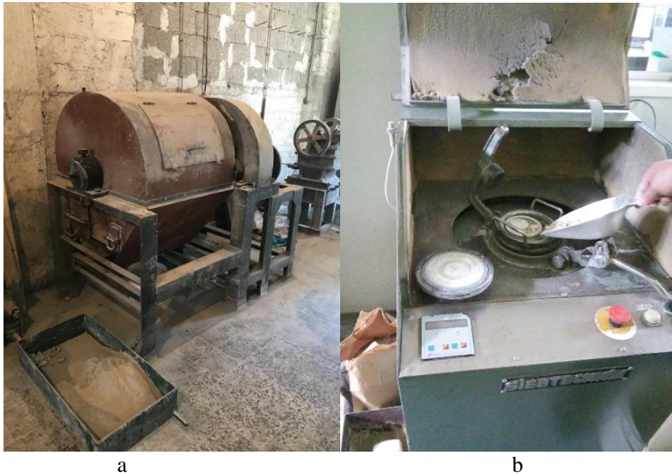
Slika 19. Poluindustrijski kuglični mlin (a) i laboratorijski mlin (b)
