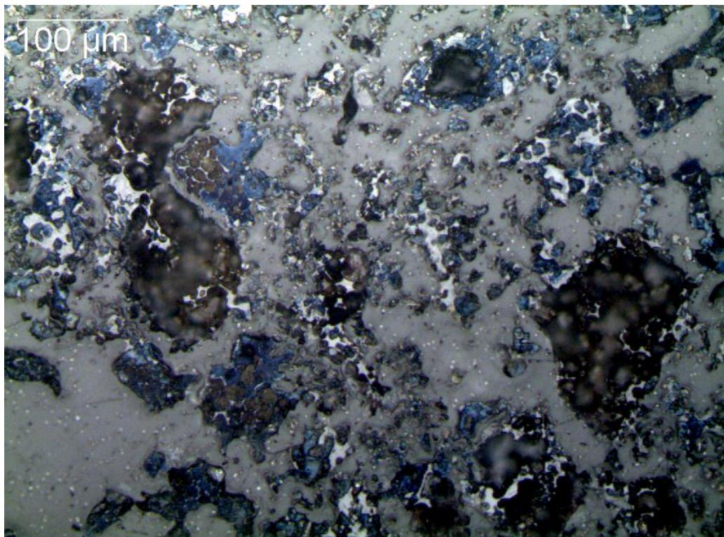
**Slika 29.** Uzorci klinkera snimljeni pri povećanju od 20x
