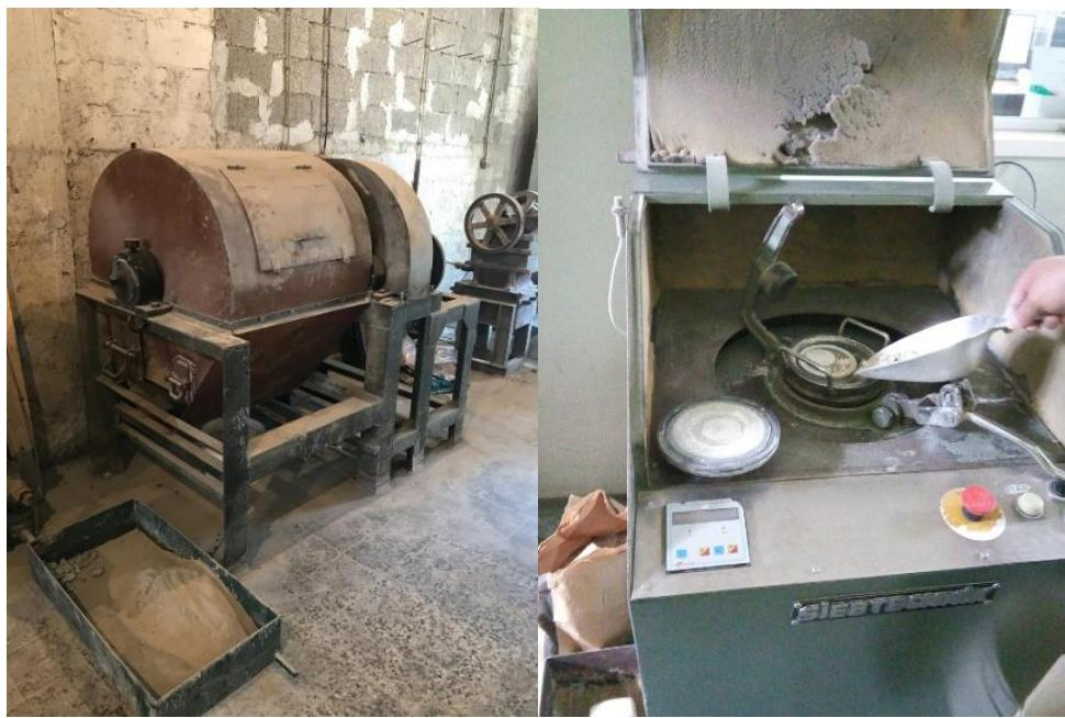
**Slika 19.** Poluindustrijski kuglični mlin (a) i laboratorijski mlin (b)
