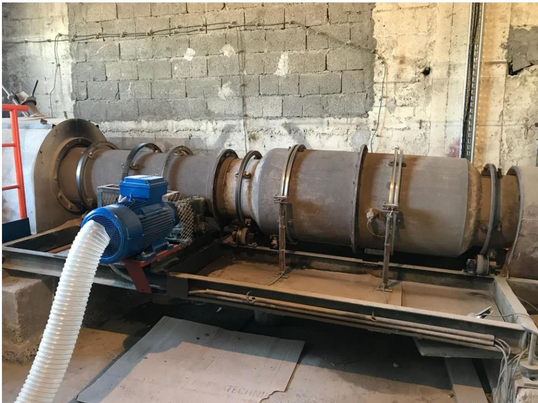
**Slika 27.** Rotacijska peć poluindustrijske izvedbe
