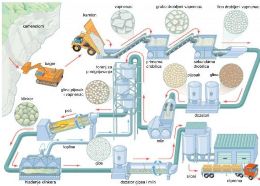
Slika 1. Moderni postupak proizvodnje cementa [5]
