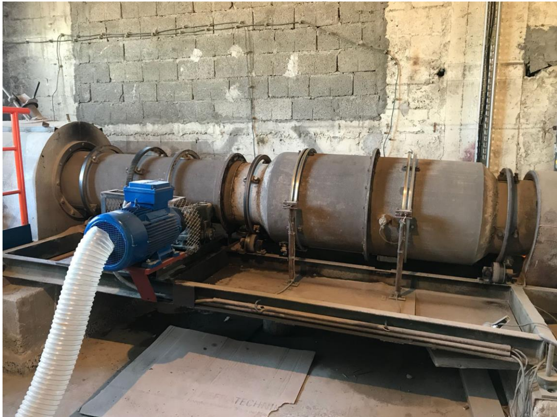
Slika 27. Rotacijska peć poluindustrijske izvedbe
