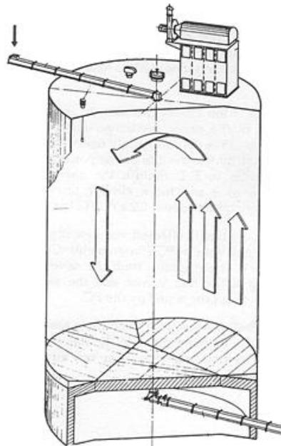
**Slika 12.** Silos homogenizacije procesom dijeljenog toka materijala [7]
