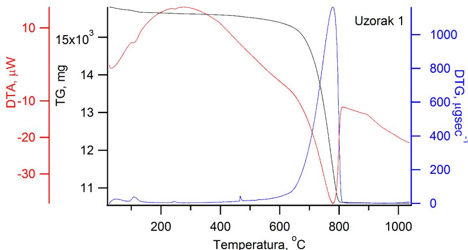
**Slika 25.** TG/DTG-DTA snimak uzorka označenog sirovine (uzorak 1)
