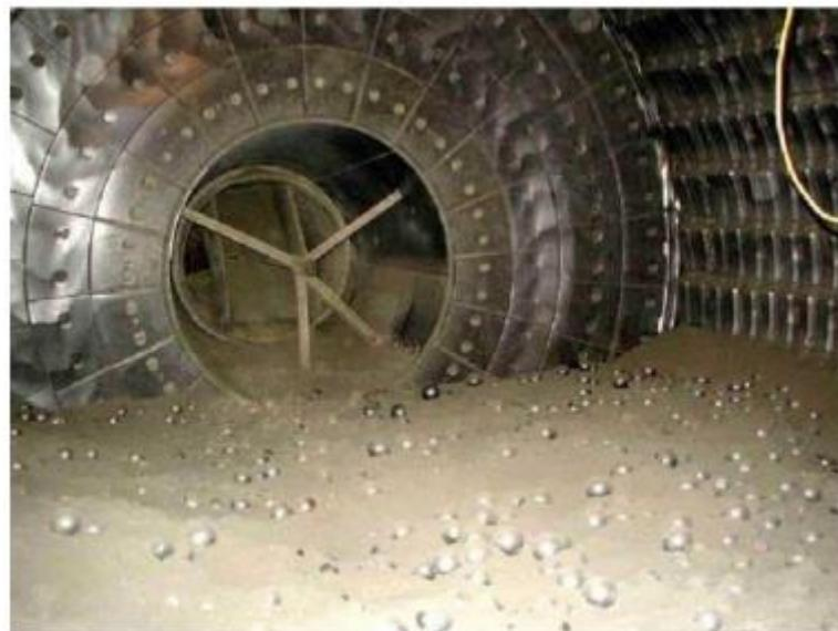
**Slika 18.** Unutrašnjost mlina s kuglama za mljevenje klinkera [5]
