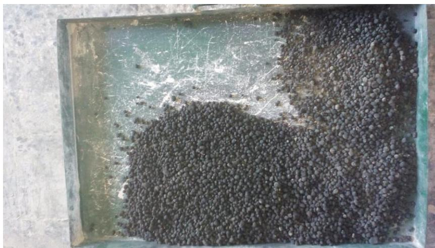
**Slika 21.** Dobiveni klinker uslijed pečenja na poluindustrijskoj peći
