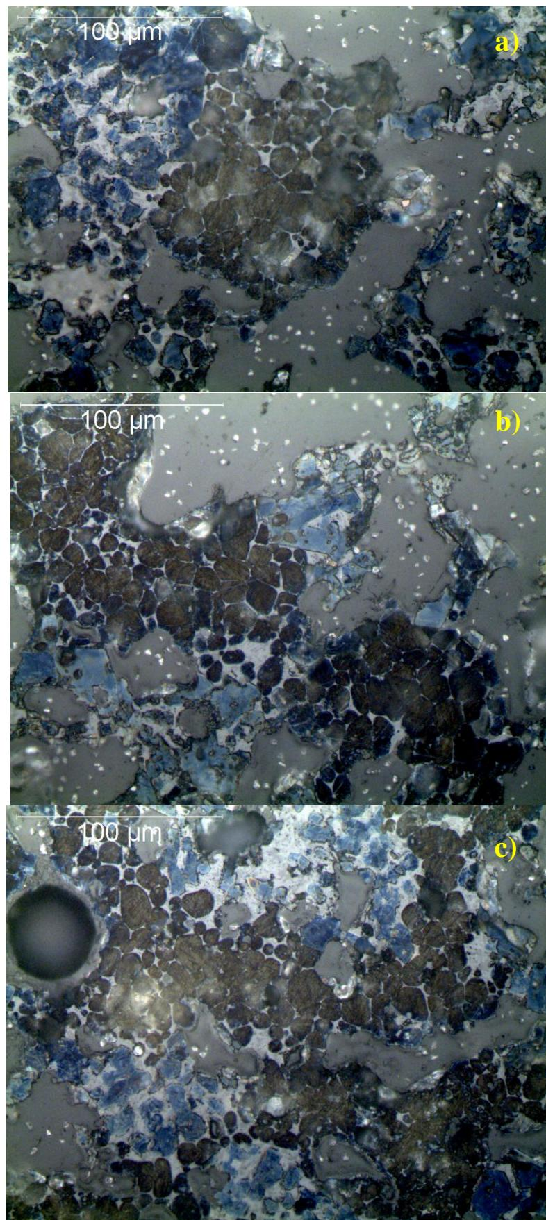
**Slika 30.** Uzorci klinkera snimljeni pri povećanju od 50x
