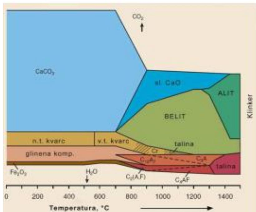
**Slika 16.** Shematski prikaz nastajanja minerala klinkera u ovisnosti o sastavu sirovinske smjesi i temperaturi u rotacijskoj peći [4]
