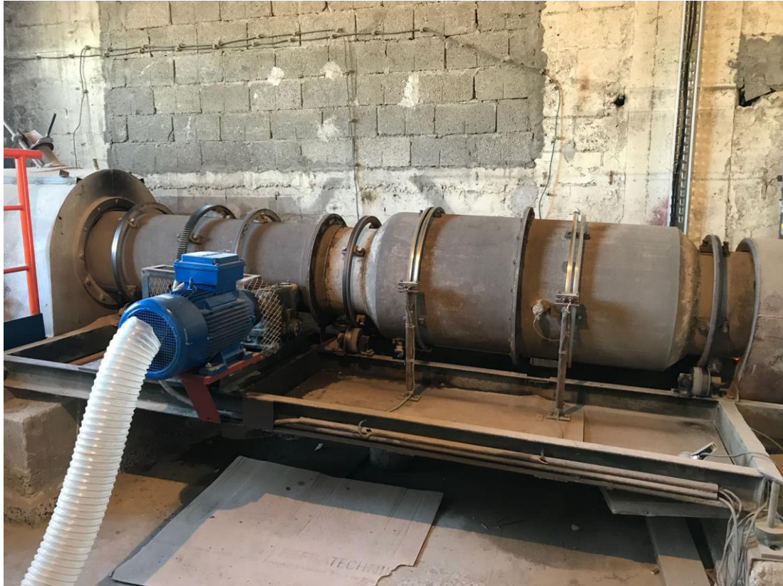
Slika 27. Rotacijska peć poluindustrijske izvedbe
