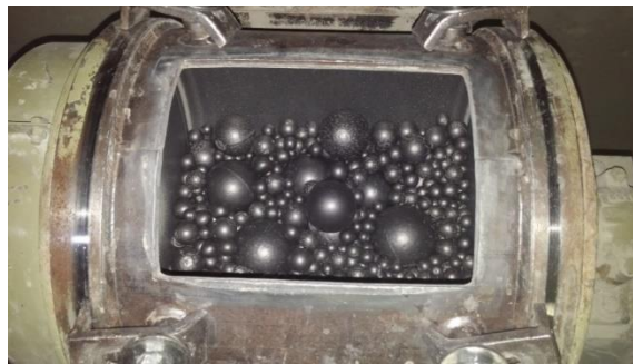
Slika 7. Punjenje poluindustrijskog horizontalnog mlina s čeličnim kuglama [13]
