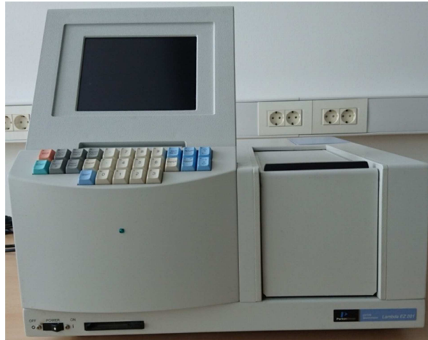
Slika 2.4. Spektrofotometar Perkin Elmer Lambda EZ 20.
