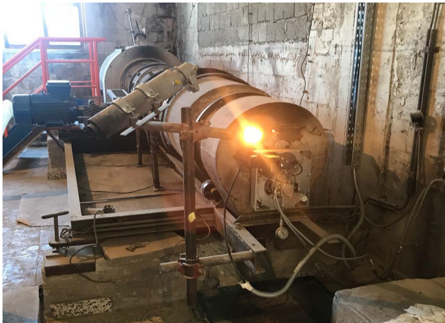
Slika 13. Rotacijska peć za sintezu cementnog klinkera
