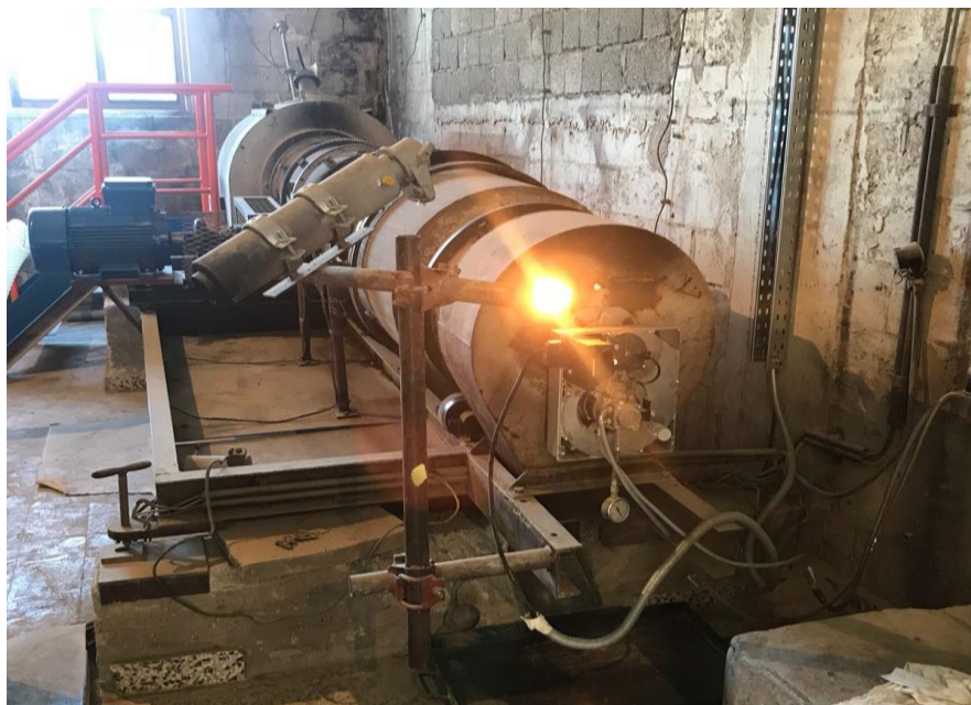
Slika 13. Rotacijska peć za sintezu cementnog klinkera
