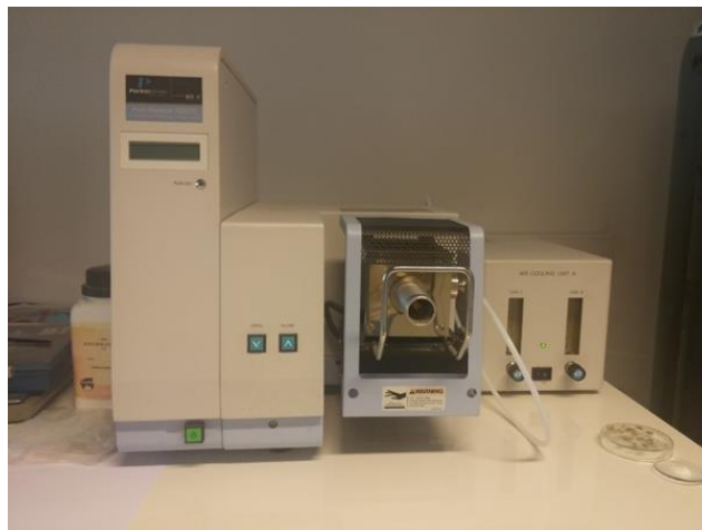
Slika 15. TG/DTG-DTA uređaj proizvođača Perkin Elemer, model Pyris Diamond
