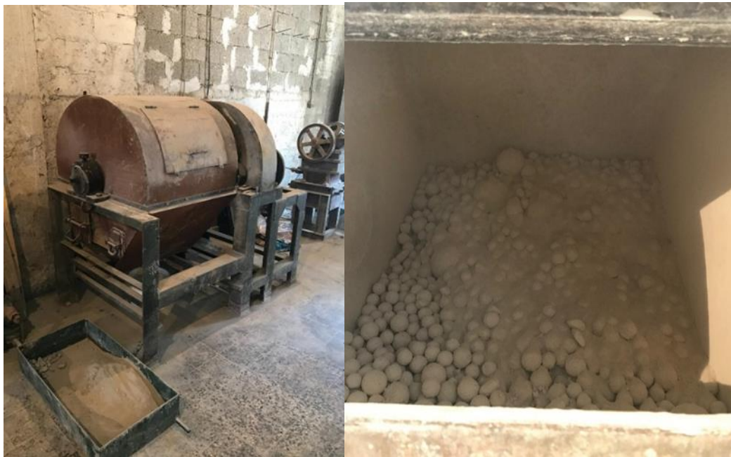
Slika 11. Horizontalni kuglični mlin (a), punjenje mlina s čeličnim kuglama(b)
