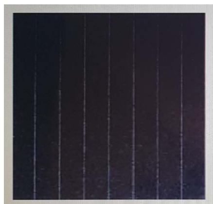
**Slika 5.** Solarna čelija na bazi bakar-indij-diselenida (CIS)<sup>4</sup>
