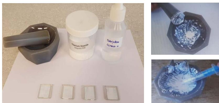
**Slika 13.** Postupak priprave  $TiO_2$  paste
