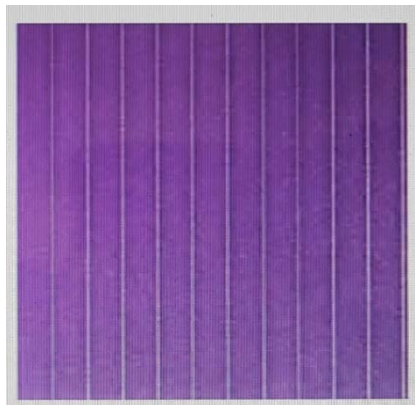
Slika 6. Amorfna silicijeva ćelija (a-Si) 4
