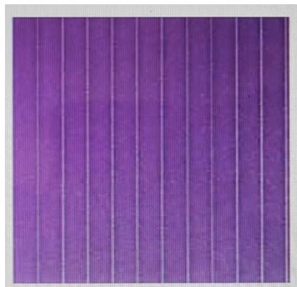
**Slika 6.** Amorfna silicijeva čelija (a-Si)<sup>4</sup>
