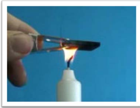
Slika 15. Nanošenje ugljičnog sloja
