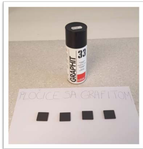
Slika 16. Nanošenje grafitnog sloja iz spreja
