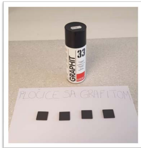
Slika 16. Nanošenje grafitnog sloja iz spreja
