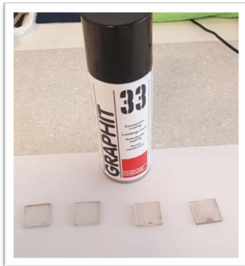
Slika 16. Nanošenje grafitnog sloja iz spreja
