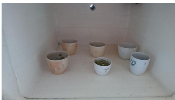
Slika 2.10. Uzorci pripremljeni za žarenje u peći na 500 °C
