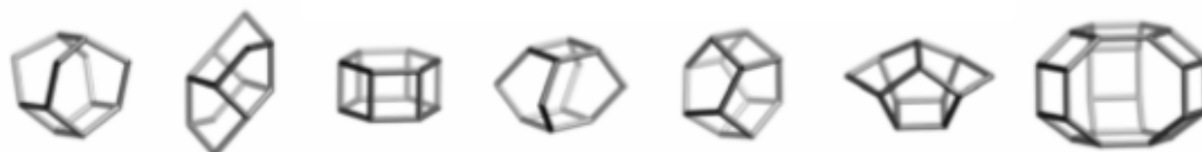
Slika 1.7. Tercijarne strukturne jedinice zeolita 13
