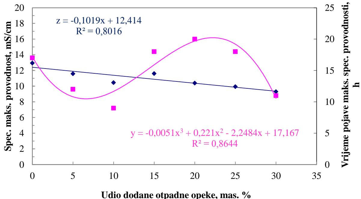
Pomoću ovih modela moguće je procijeniti vrijednost maksimalne specifične provodnosti i vrijeme pojave maksimalne specifične provodnosti za uzorke cementnih suspenzija uz različite dodatke otpadne građevinske opeke. Prema slici 9 ovisnost specifične provodnosti o udjelu otpadne opeke opisana je funkcijom:
