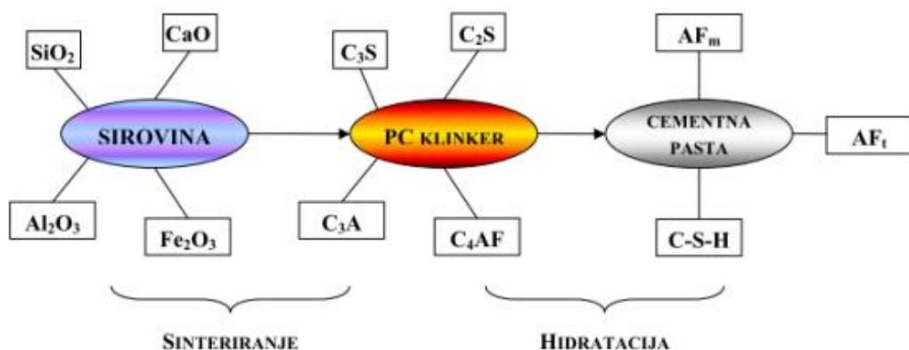
**Slika 2.** Shematski prikaz promjene oblika tijekom pečenja i hidratacije dobivenog portland cementa
