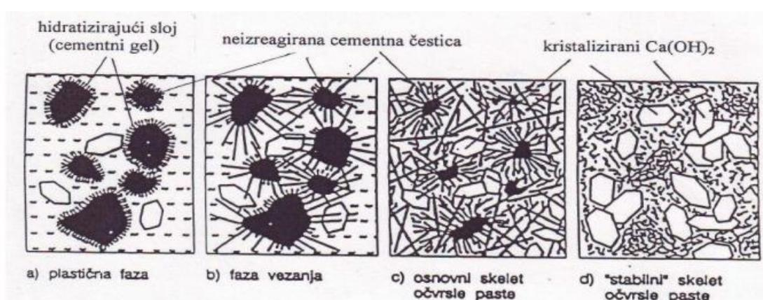
**Slika 5. Shematski prikaz nastajanja strukture očvrsle cementne paste**
