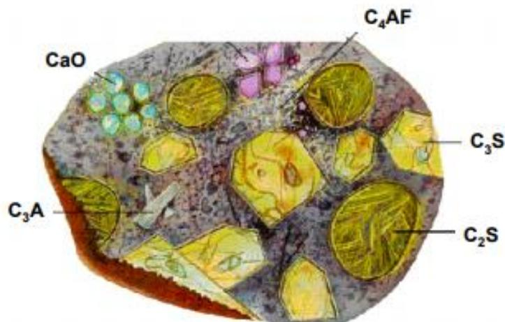
**Slika 1.** Poprečni presjek zrna cementa<sup>5</sup>
