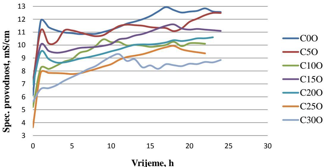
**Slika 8.** Ovisnosti specifične električne provodnosti o vremenu za cementne suspenzije
