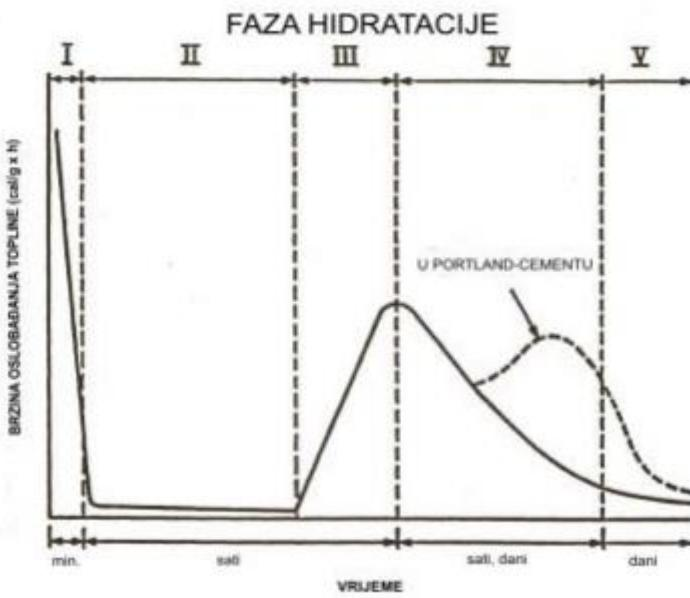
**Slika 4.** Krivulja razvijene topline tijekom hidratacije  $C_3S$ -a i portland cementa<sup>7</sup>
