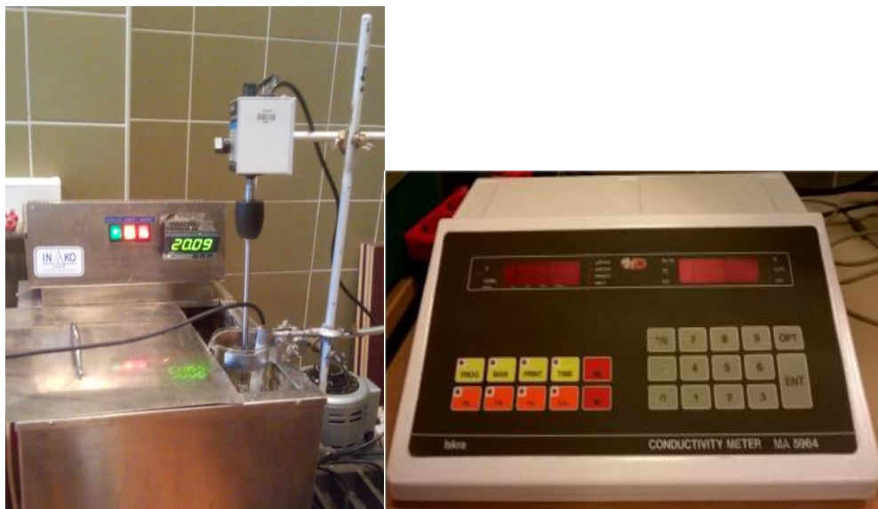
Slika 7. Aparatura za određivanje specifične električne provodnosti
