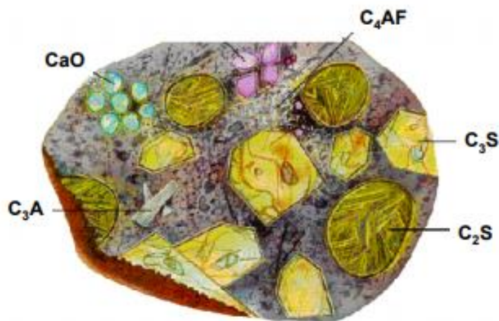
Slika 1. Poprečni presjek zrna cementa 5
