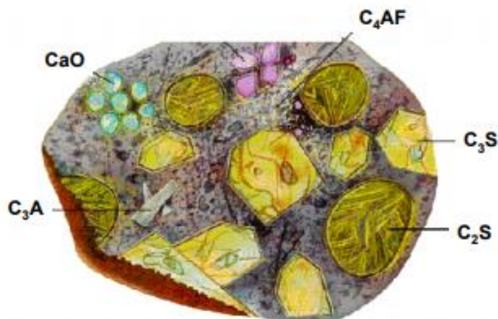
Slika 1. Poprečni presjek zrna cementa 5
