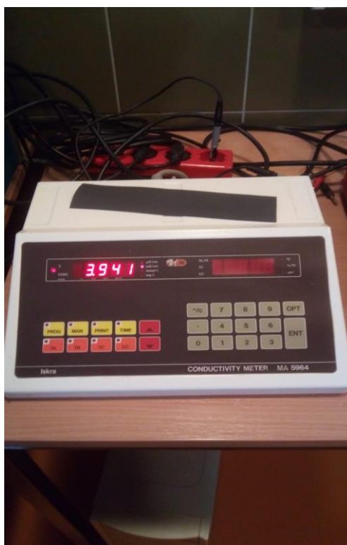
Slika 5. Aparatura korištena za određivanje specifične provodnosti: a) osobno računalo b) mjerna posuda u termostatiranoj vodenoj kupelji c) konduktometar MA 5964 – ISKRA
