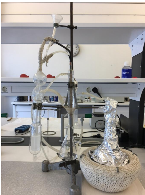
Slika 14. Aparatura za mikrodestilaciju po Kjeldahlu
