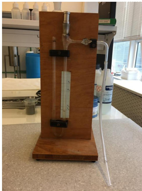
Slika 15. Blaine-ov zračni permeabilimetar
