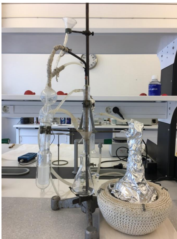
Slika 14. Aparatura za mikrodestilaciju po Kjeldahlu
