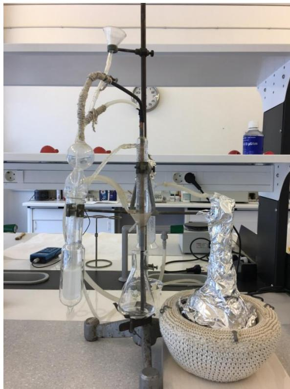
**Slika 14.** Aparatura za mikrodestilaciju po Kjeldahlu
