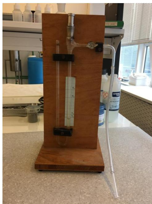
**Slika 15.** Blane-ov zračni permeabilimetar
