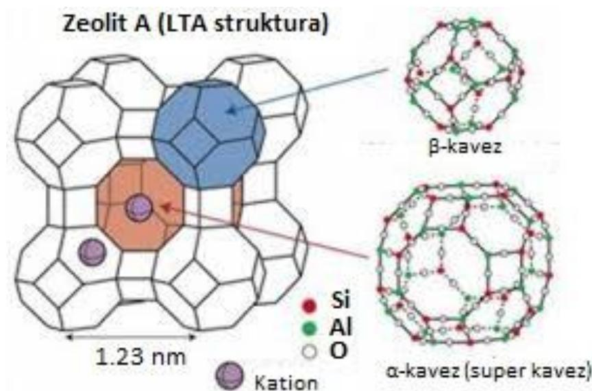
**Slika 4.** Struktura zeolita A.<sup>4</sup>
