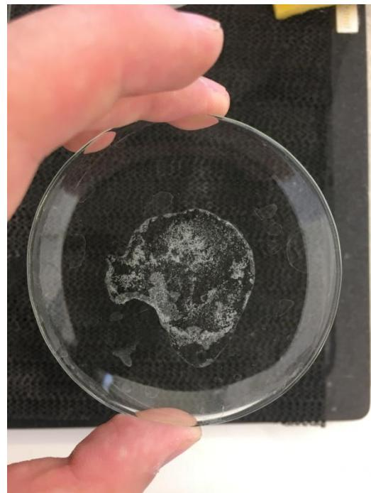
**Slika 13.** Testiranje na kloride sa srebrovim nitratom
