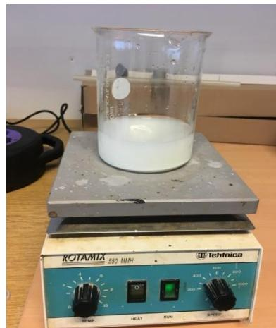
**Slika 8.** Otapanje natrijevog silikata i natrijevog aluminata u destiliranoj vodi.
