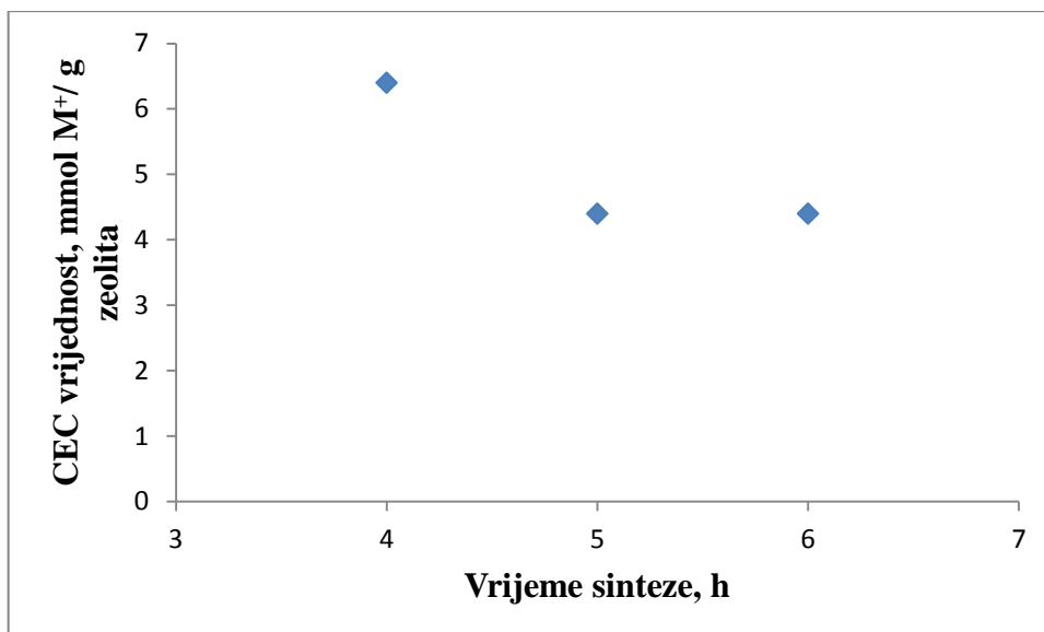
Slika 16. Grafička ovisnost CEC vrijednost o vremenu sinteze
