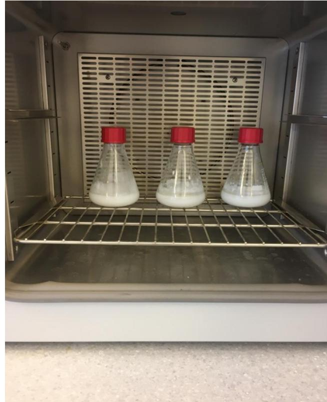
**Slika 10.** Sinteza zeolita A s različitim vremenima sinteze.
