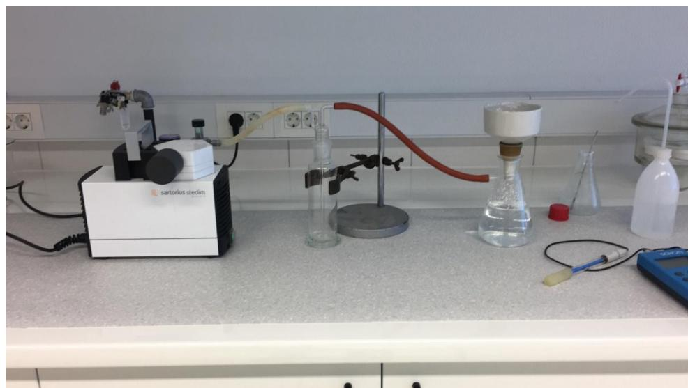
**Slika 11.** Ispiranje uzorka demineraliziranim vodom kroz Büchnerov lijevak uz korištenje vakuum pumpe.
