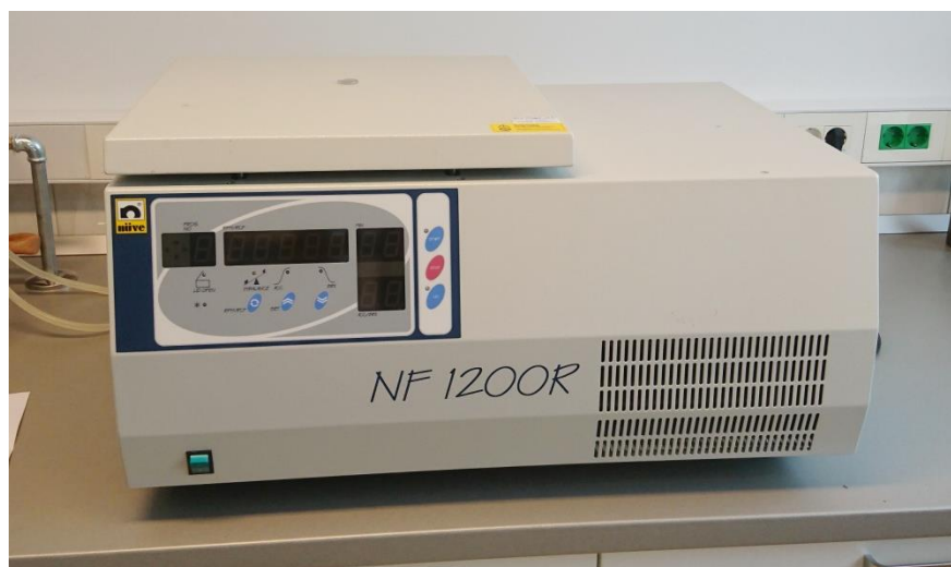
Slika 27. Centrifuga korištena za pripravu otopine sulfataze.
