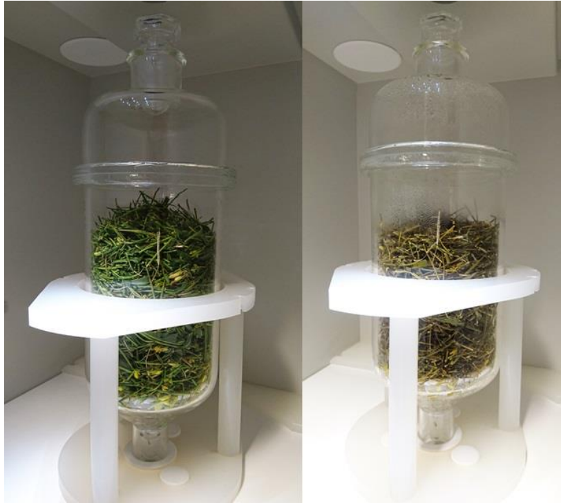
Slika 22. Biljni materijal prije i poslije mikrovalne destilacije.
