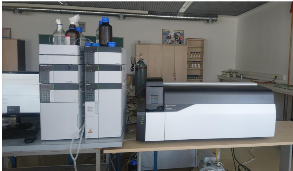
Slika 37. HPLC-DAD-MS/MS uređaj (Shimadzu, Japan).
