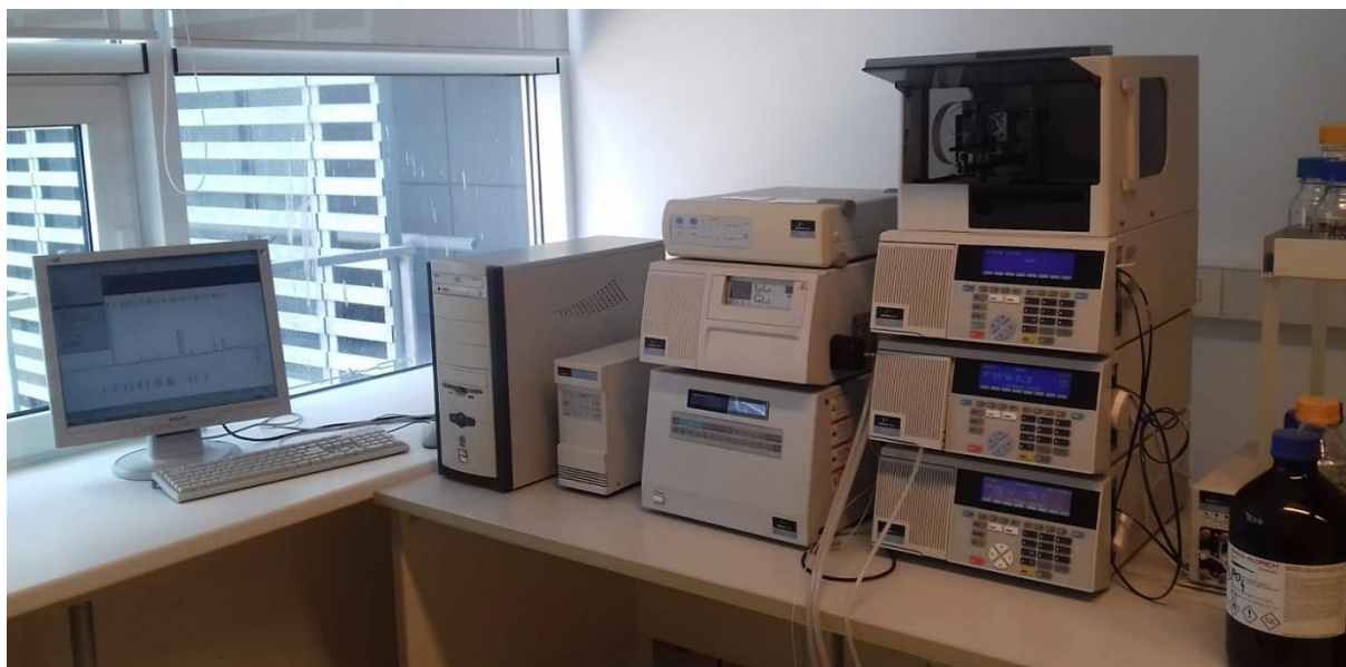
Slika 36. HPLC uređaj (PerkinElmer, USA).
