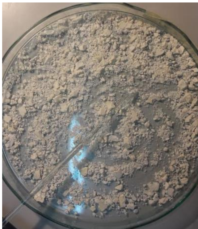
Slika 2.20. Osušeni i usitnjeni talog 2-metil-6-fenil-piridin-3,4-dikarboksilne kiseline.
