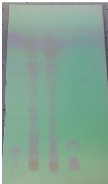
Slika 2.8. TLC pločica nakon reakcije hidrolize.
