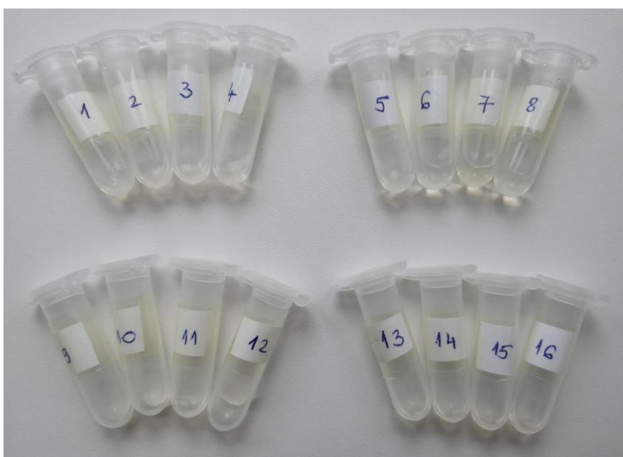
Slika 2.48. Uzorci nakon probave i desulfatacije.
