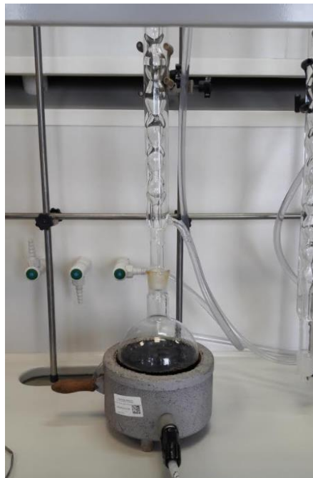
Slika 2.10. Dodatno refluksiranje smjese tijekom 2,5 h.
