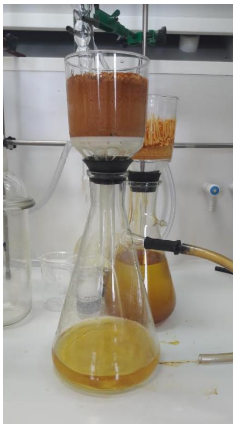
Slika 2.13. Filtracija taloga preko Büchnerovog lijevka.
