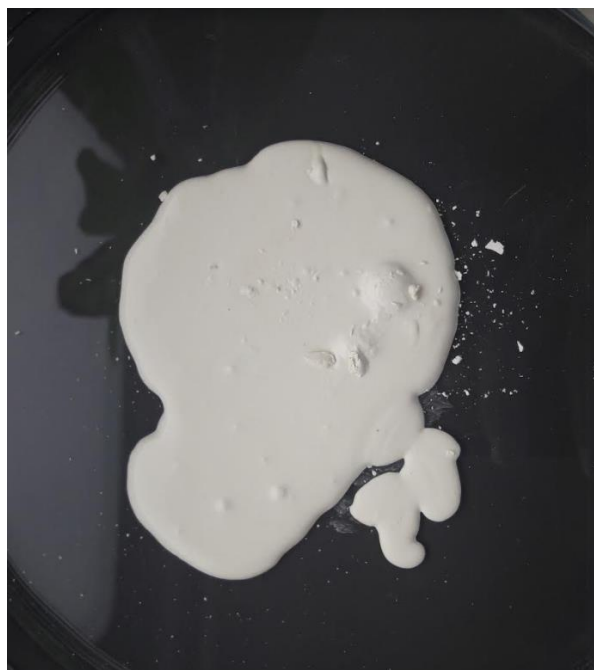
Slika 2.19. Vlažni talog pročišćene 2-metil-6-fenil-piridin-3,4-dikarboksilne kiseline.
