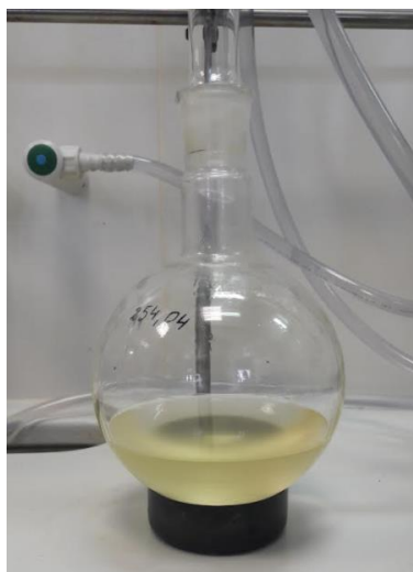
Slika 2.25. Otopljeni 4-metil-6-fenil-furo[3,4- c ]piridin-1,3-dion i nečistoće u toluenu odmah nakon refluksa.
