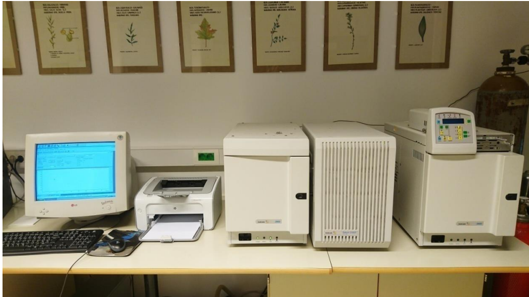
Slika 2.1. GC-MS uređaj (Varian, USA).
