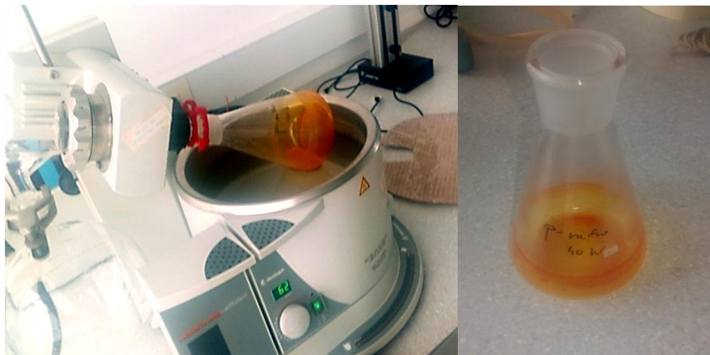
Slika 38. Uparavanje diklormetana i dodatak petroletera
