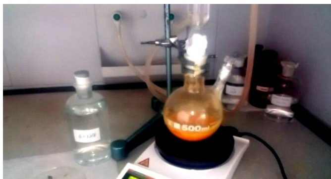
Slika 35. Dodatak 6M NaOH do pH>11
