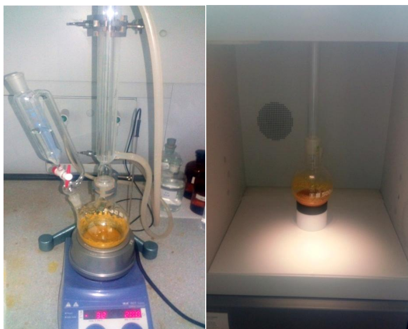
Slika 28. Promjena boje reakcijske smjese dodatkom K 2 CO 3 otopljenog u vodi i DMF-u
