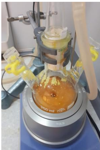
Slika 26. Boja reakcijske smjese nakon zaluživanja 6M NaOH
