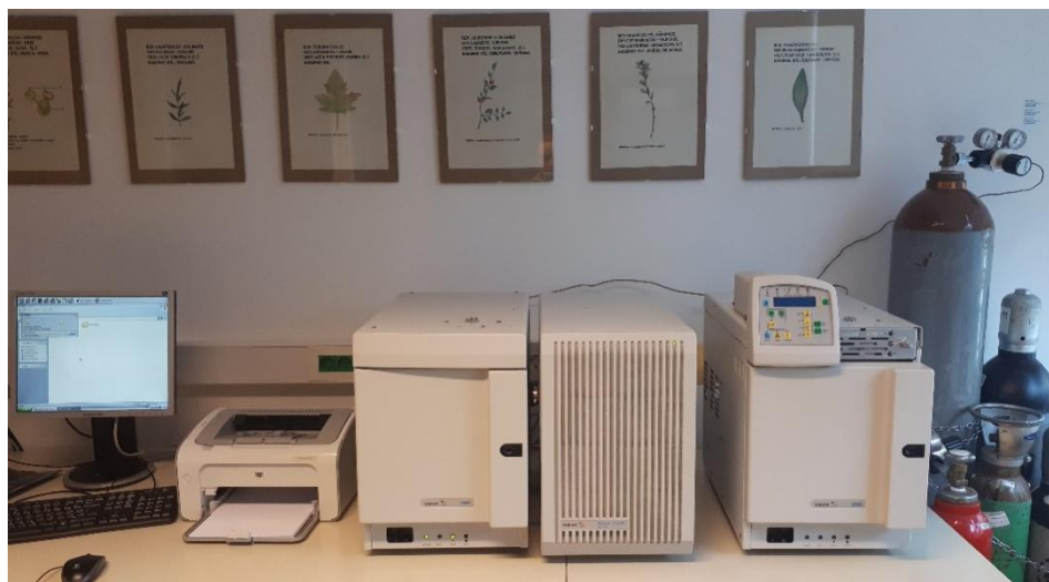
Slika 42. Korištena GC-MS instrumentacija
