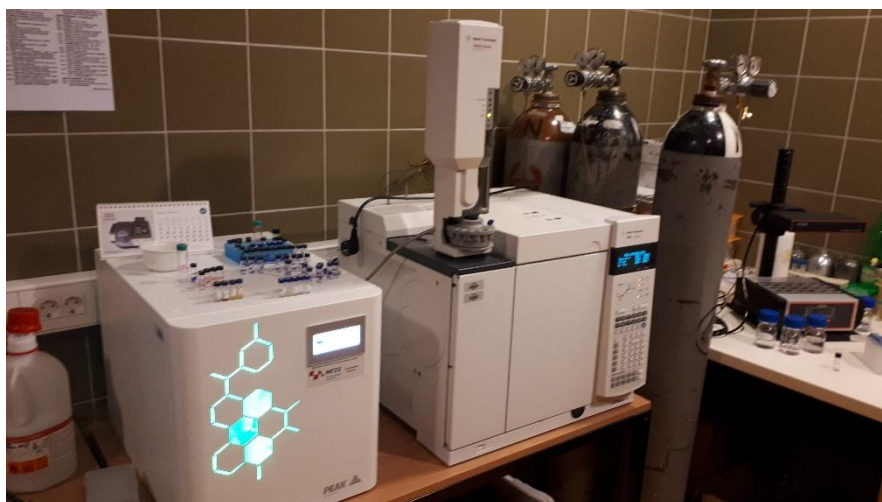
Slika 41. Uređaj za plinsku kromatografiju s plamenoionizacijskim detektorom
