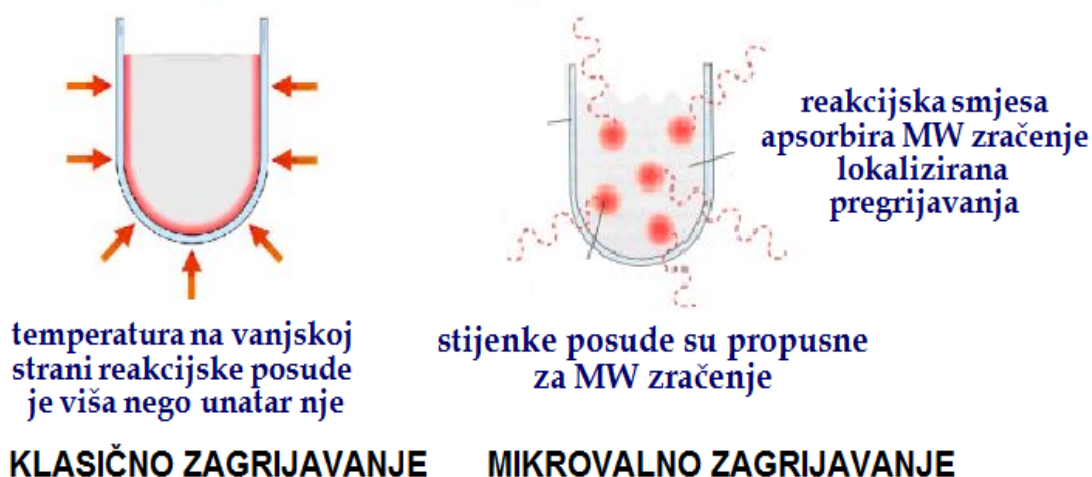
Slika 16. Usporedba klasičnog i mikrovalnog zagrijavanja 11
