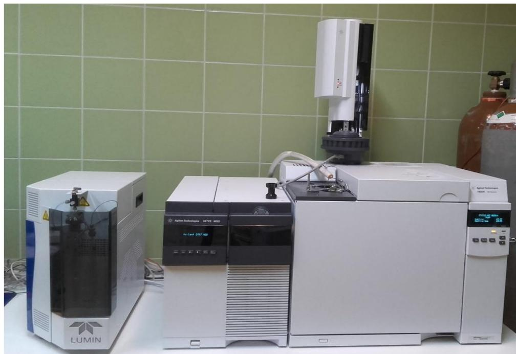
*Slika 11.* Vezani sustav plinska kromatografija-spektrometrija masa (GC-MS)
