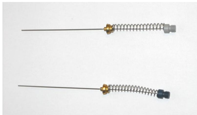
**Slika 10.** Vlakna s ovojnicama DVB/CAR/PDMS (sivo vlakno) i PDMS/DVB (plavo vlakno) (20)
