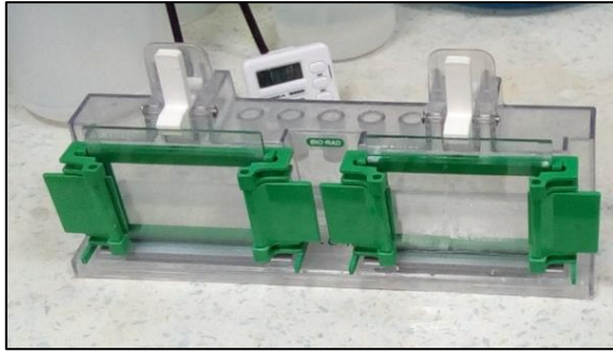
Slika 17: Izrada gelova za elektroforezu
