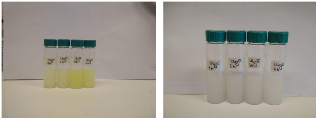
Slika 10. Otopina eteričnog ulja klinčića nakon dodatka peroksidaze, a) odmah po dodatku enzima, b) nakon 4 sata
