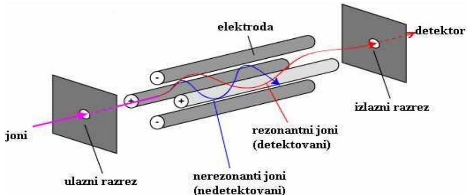
**Slika 15.** Shema kvadrupolnog analizatora
