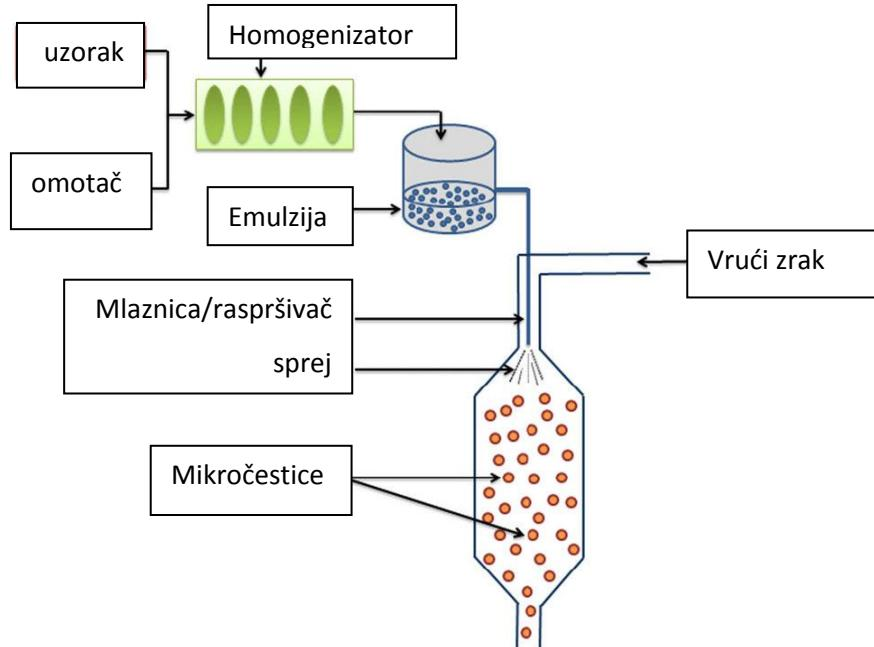
**Slika 17.** Sušenje raspršivanjem (engl. Spraydrying)
