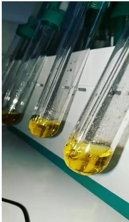
Slika 6. Uzorci ulja postavljeni na uređaj Rancimat (vlastita fotografija)
