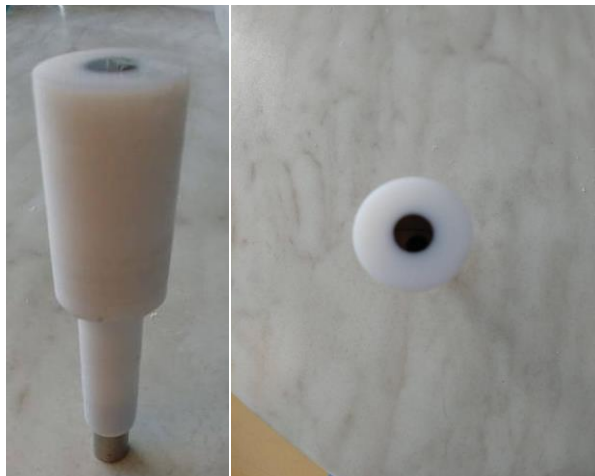
Slika 20. GCE – radna elektroda
