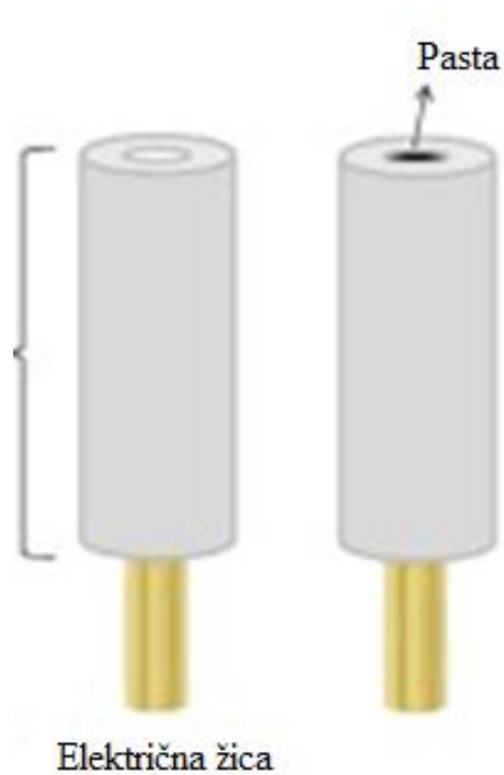
Slika 4 - Osnovna konstrukcija elektrode od ugljikove paste, električna žica za kontakt, pasta i cijev [19]
