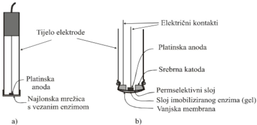
**Slika 18-** Biosenzori za glukoza zasnovani na anodnoj oksidaciji  $\text{H}_2\text{O}_2$ , s immobiliziranim enzimom na površini najljonske mrežice (a) I u polimernom gelu (b)
