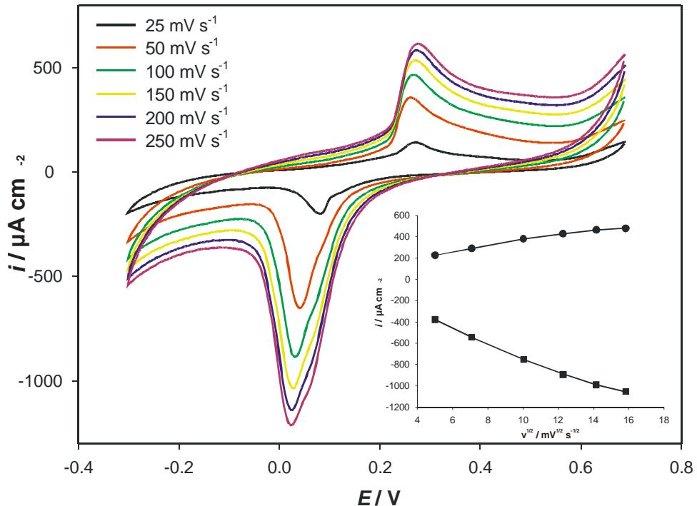
**Slika 47 -** Utjecaj posmika na CV- modifikacija s 5%  $\text{AgCuS}$  pri pH 4 koncentracije  $10^{-4}$  uz dodatak  $\text{H}_2\text{O}_2$
