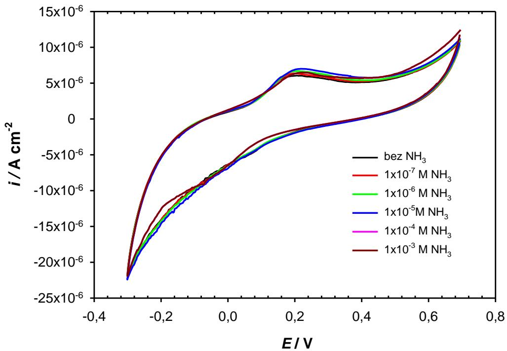
*Slika 42- Snimljeni ciklički voltamogram modificirane elektrode s 5% Ag<sub>2</sub>S pri pH 7*
