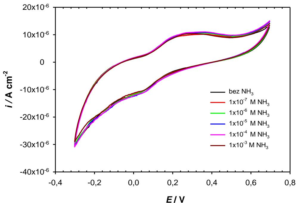
Slika 41- Snimljeni ciklički voltamogram modificirane elektrode s 5% Ag<sub>2</sub>S pri pH 5
