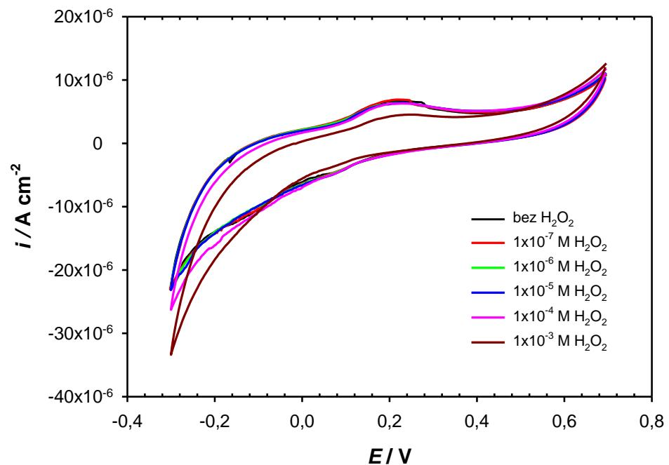
*Slika 36- Snimljeni ciklički voltamogram modificirane elektrode s 5% Ag<sub>2</sub>S pri pH 7*
