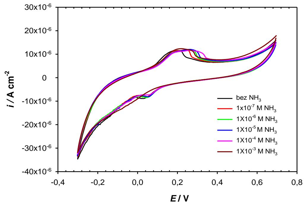
*Slika 43- Snimljeni ciklički voltamogram modificirane elektrode s 5% Ag<sub>2</sub>S pri pH 9*
