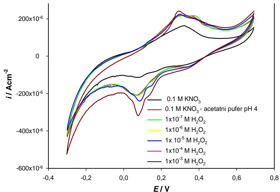
**Slika 44-** Elektroda s 10 % modifikatora AgCuS pri pH 4
