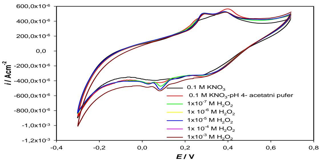
**Slika 45-** Elektroda s 20% modifikatora AgCuS pri pH 5
