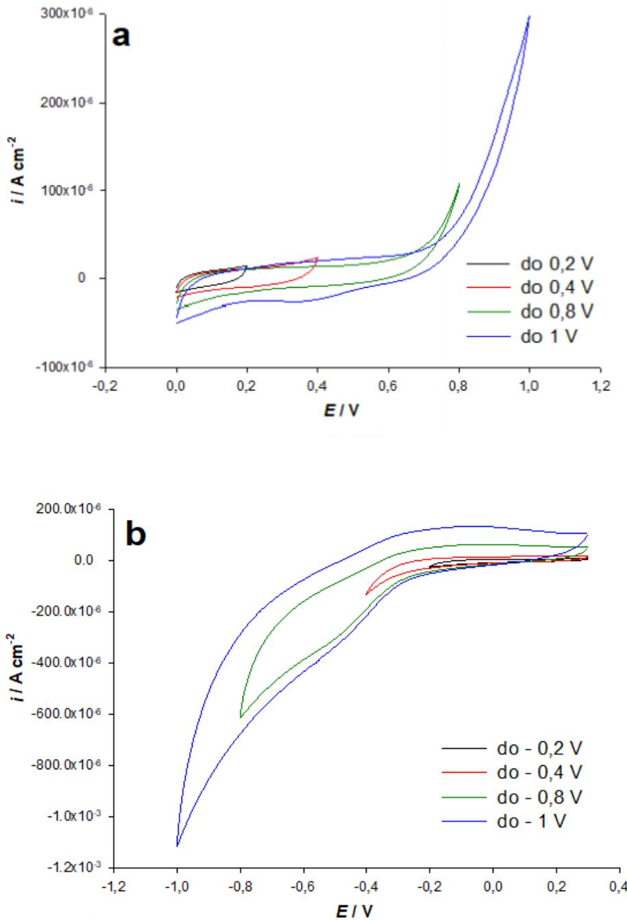
**Slika 25-** Utjecaj pomaka anodne (a) i katodne (b) granice na cikličke voltamograme nCPE u osnovnom elektrolitu,  $0,1 \text{ mol dm}^{-3} \text{KNO}_3$
