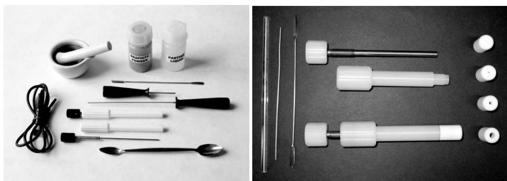
**Slika 21-** Materijal i pribor za izradu elektroda od ugljika
