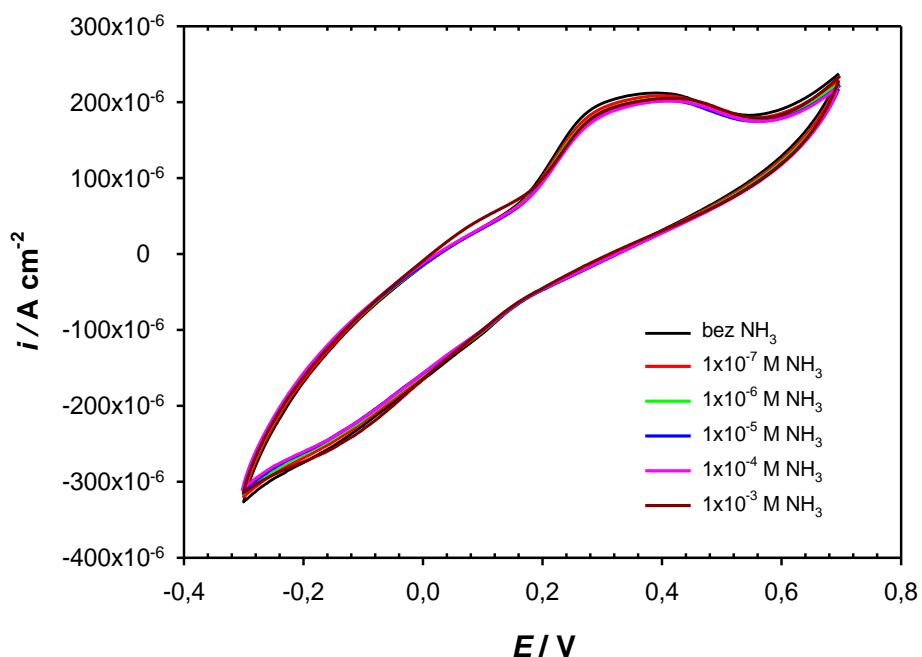
**Slika 40-** Snimljeni ciklički voltamogram modificirane elektrode s 5% AgCuS pri pH 9
