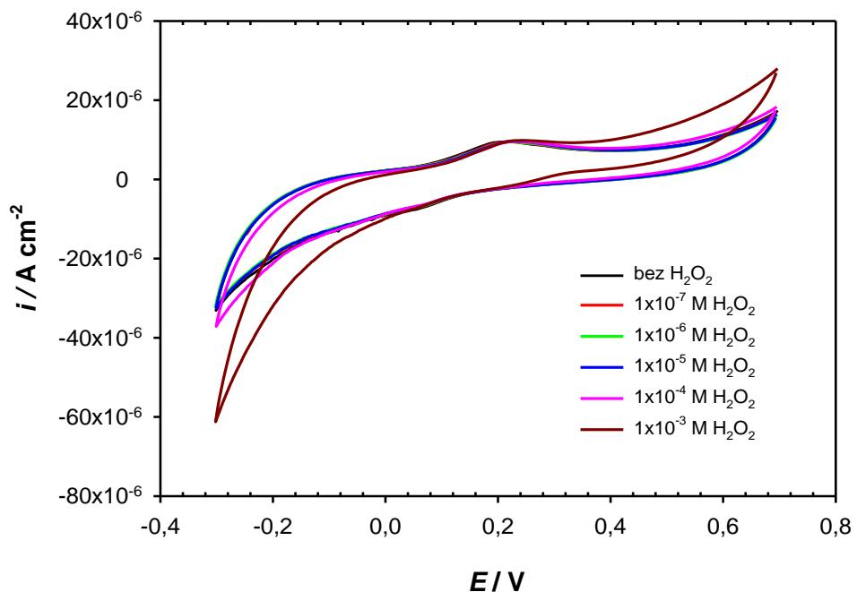
*Slika 37- Snimljeni ciklički voltamogram modificirane elektrode s 5% Ag<sub>2</sub>S pr*
