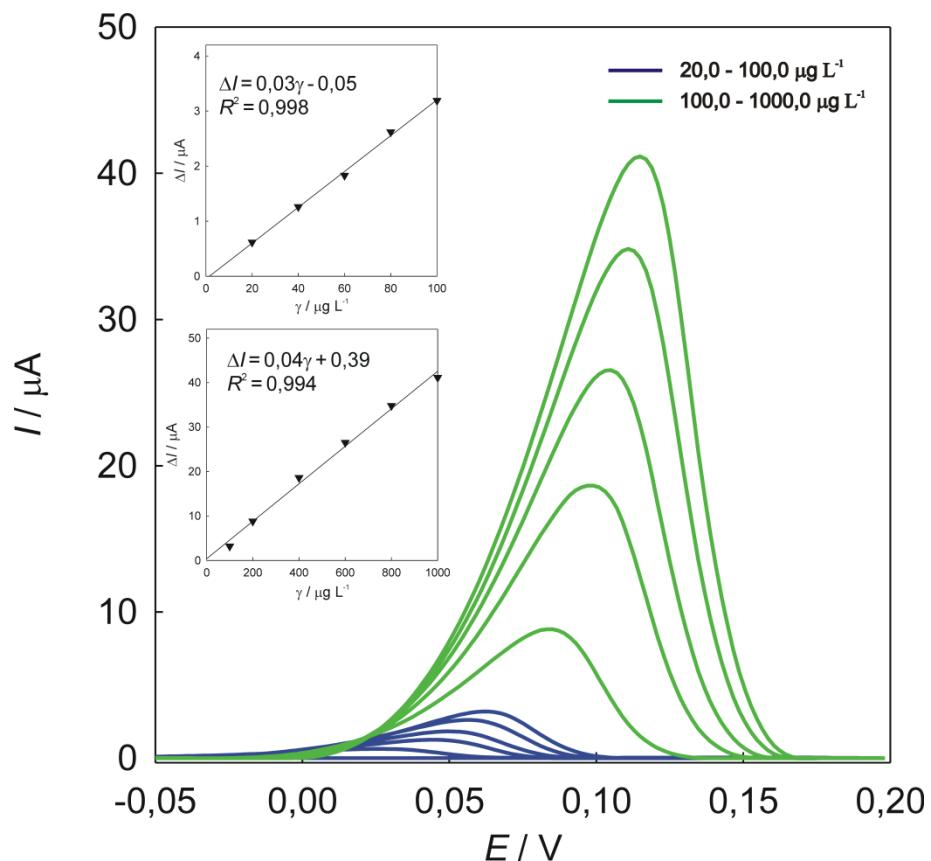
**Slika 15.** SW voltamogram s osnovnom korekcijom, zabilježen na HAp-filmu / GCE u  $0,2 \text{ mol dm}^{-3}$  elektrolitu  $\text{KNO}_3$  ( $\text{pH} = 4$ ) s pripadajućim krivuljama umjeravanja.
