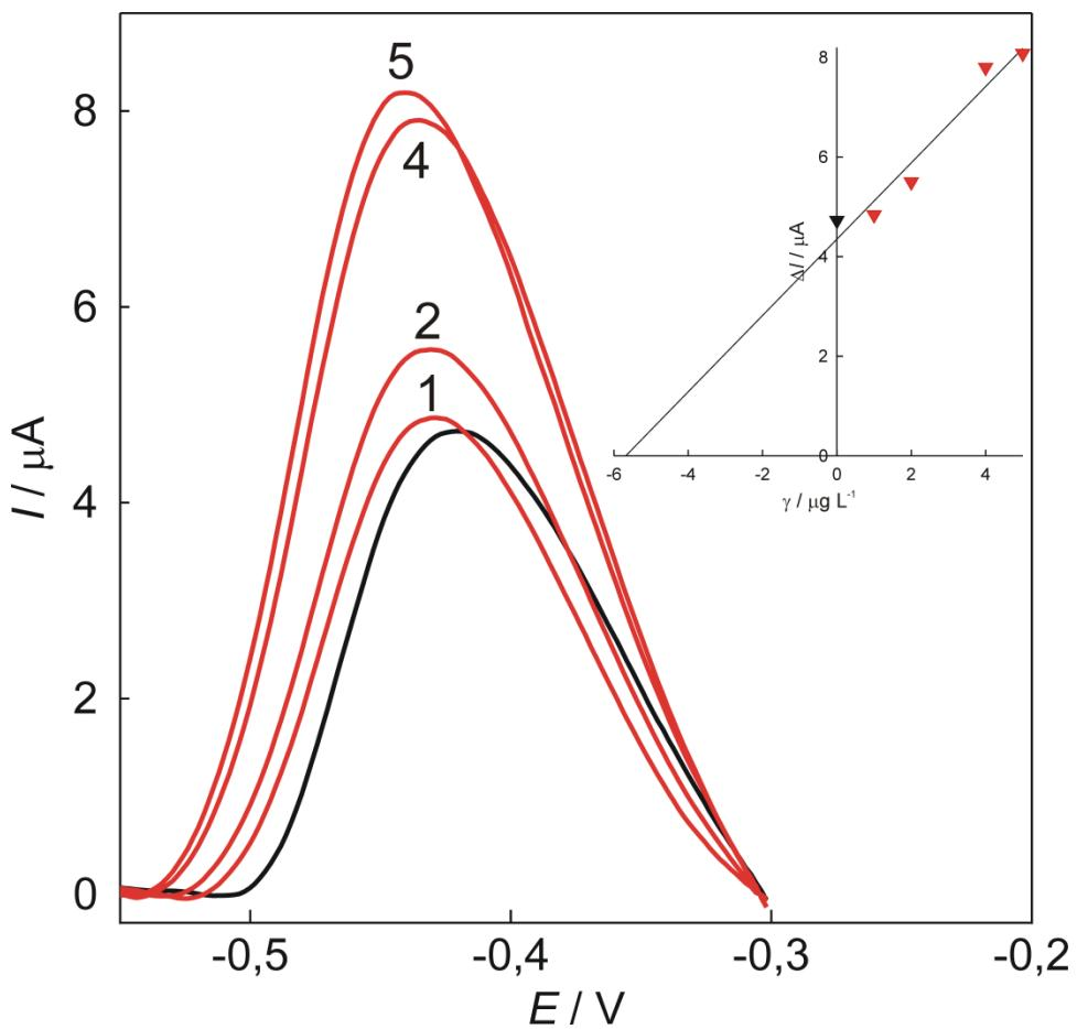
**Slika 20.** SW voltamogram (korigirani za vrijednost bazne linije) s pripadajućim krivuljama umjeravanja u svrhu određivanja nepoznate koncentracije olova u realnom uzorku šećera metodom standardnog dodatka.
