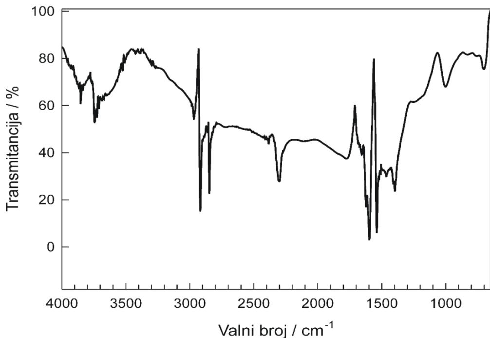
**Slika 14.** FTIR spektar elektrode od staklastog ugljika na koju je elektrodeponiran hidroksiapatit ( $\text{HAp}$ ,  $\text{Ca}_{10}(\text{PO}_4)_6(\text{OH})_2$ ).
