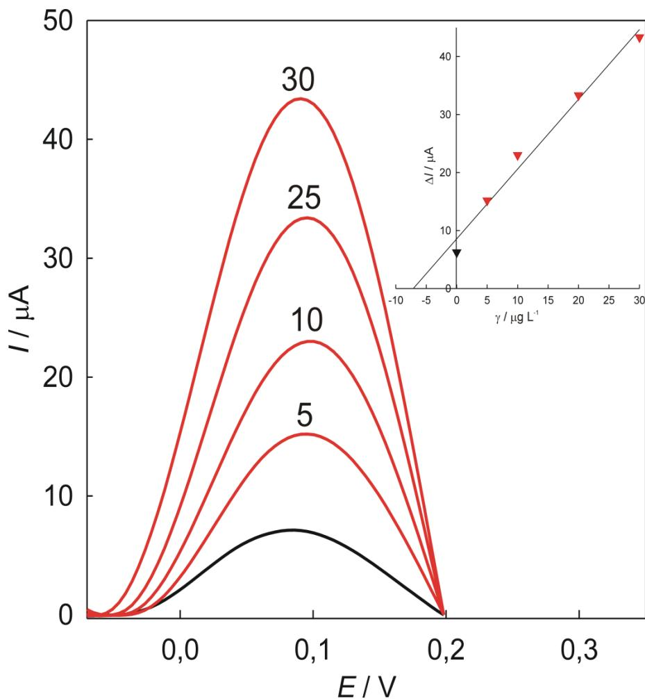
**Slika 18.** SW voltamogram (korigirani za vrijednost bazne linije) s pripadajućom krivuljom umjeravanja u svrhu određivanja nepoznate koncentracije bakra u realnom uzorku šećera metodom standardnog dodatka.
