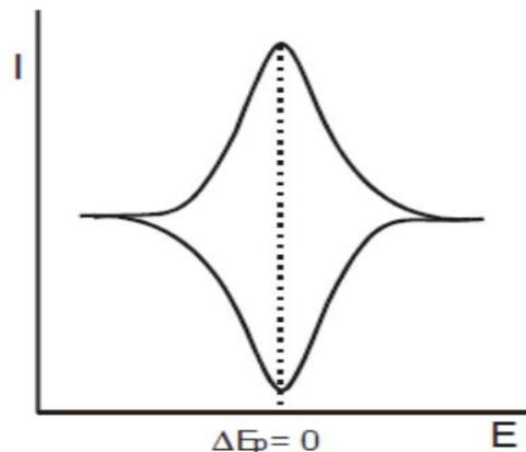
**Slika 4.** Prikaz cikličkog voltamograma za reverzibilni val elektroaktivnog sloja na elektrodi.
