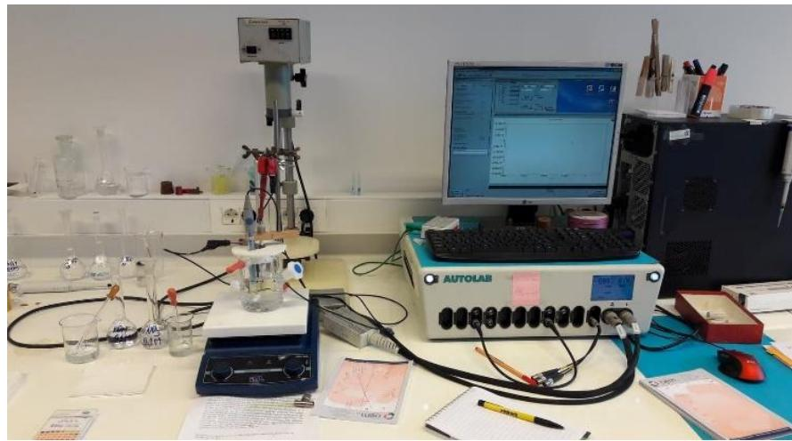
**Slika 10.** Elektrokemijska čelija sa postavljenim elektrodama (lijevo) i potenciostat sa računalom (desno).
