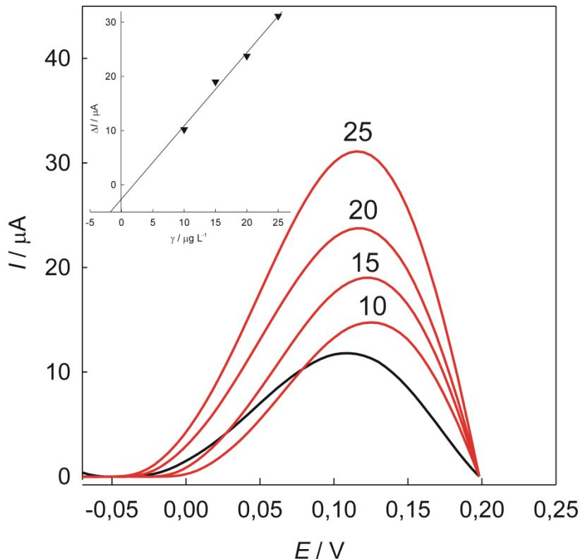
**Slika 17.** SW voltamogram (korigirani za vrijednost bazne linije) s pripadajućom krivuljom umjeravanja u svrhu određivanja nepoznate koncentracije bakra u realnom uzorku meda metodom standardnog dodatka.
