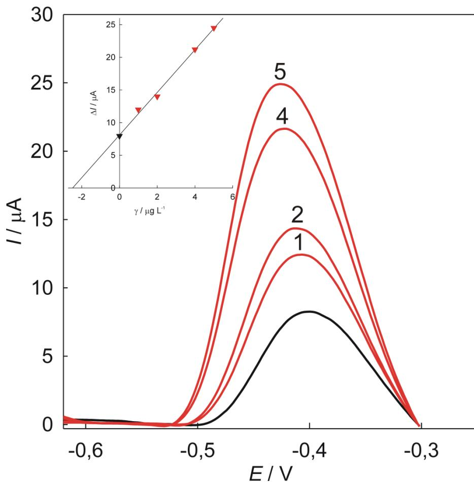
**Slika 19.** SW voltamogram (korigirani za vrijednost bazne linije) s pripadajućim krivuljama umjeravanja u svrhu određivanja nepoznate koncentracije olova u realnom uzorku meda metodom standardnog dodatka.
