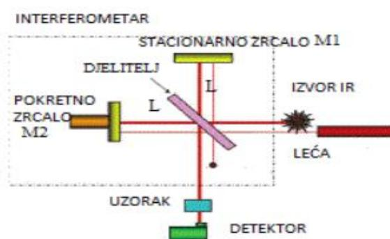
Slika 7. Konstrukcija FTIR spektrometra.
