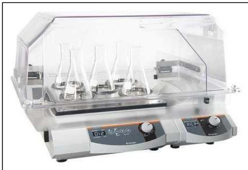
**Slika 2.10.** Inkubatorska tresilica tvrtke Heidolph<sup>47</sup>.
