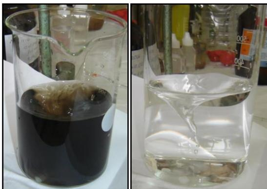
**Slika 2.6.** Prijelaz boje pri titraciji kod određivanja  $BPK^{45}$ .
