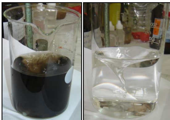
Slika 2.6. Prijelaz boje pri titraciji kod određivanja BPK 45 .
