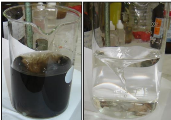
Slika 2.6. Prijelaz boje pri titraciji kod određivanja BPK 45 .
