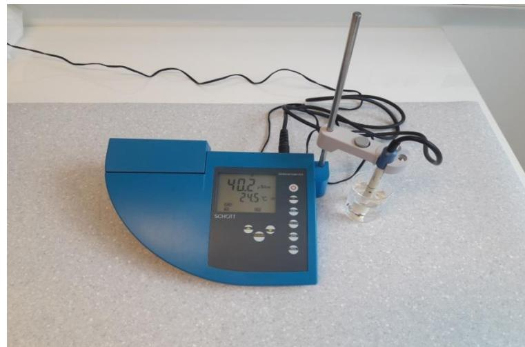
Slika 2.4. Laboratorijski konduktometar
