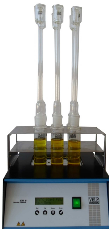
Slika 2.6. Uređaj za određivanja KPK bikromatnom metodom.
