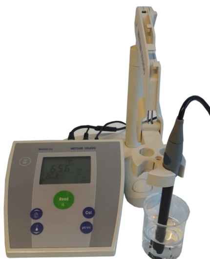
Slika 2.1. pH metar Mettler Toledo.
