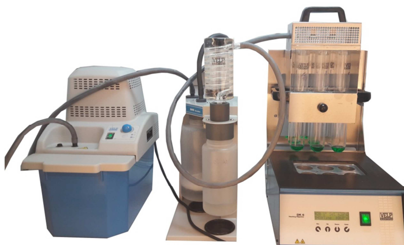
Slika 2.8. Uređaj za digestiju uzorka.
