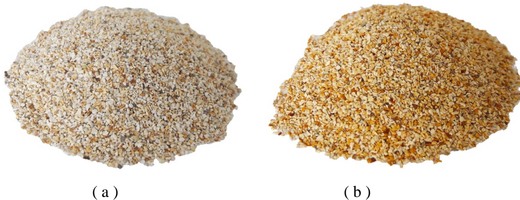
Slika 2.11. Usporedba prirodnog (a) i Fe(III)-modificiranog zeolita (b).
