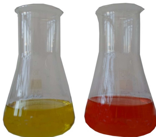
Slika 2.7. Prijelaz boje u točki ekvivalencije pri titraciji uzorka uz indikator feroin.
