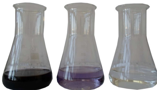
Slika 2.5. Prijelaz boje u točki ekvivalencije pri titraciji uzorka uz indikator škrob.
