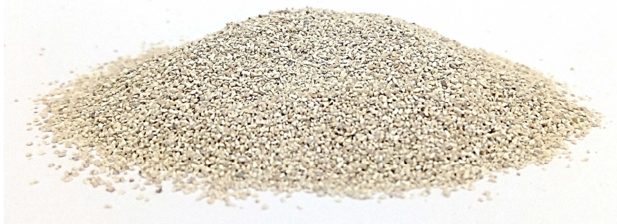
Slika 2.5. Prirodni zeolit klinoptilolit veličine čestica 0,09 - 0,56 mm.
