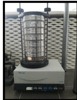
Slika 20. Treskalica sa sitima za prosijavanje
