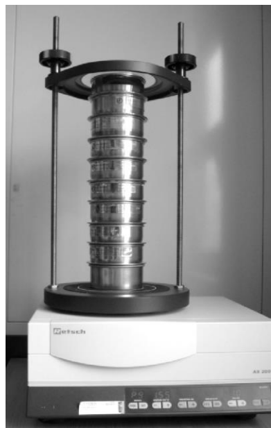
Slika 10. Aparatura za provedbu granulometrijske analize prosijavanjem.
