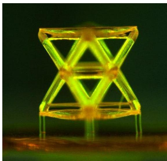
**Slika 1.2.** Mikroskopski prikaz jedinične čelije gore navedenog materijala
