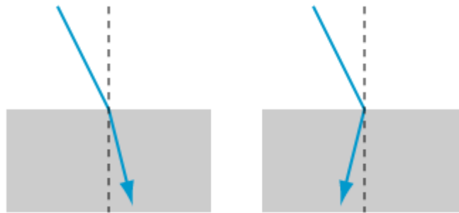
Slika 1.1. Lom svjetlosti kod konvencionalnih materijala (lijevo) i lom kod NIM (desno)
