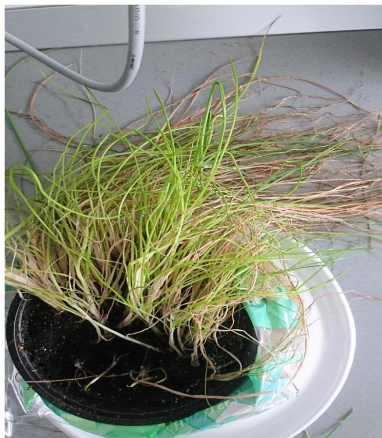
**Slika 19.** Nekroza vlasca tretiranog s bakrom (Cu) na kraju eksperimenta
