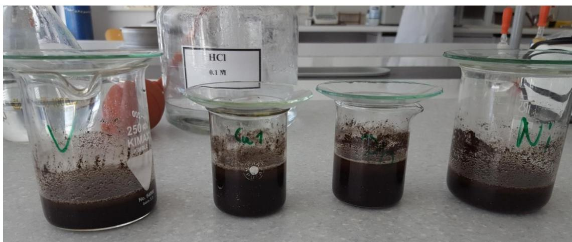
**Slika 13.** Odstajanje suspenzije tla u destiliranoj vodi
