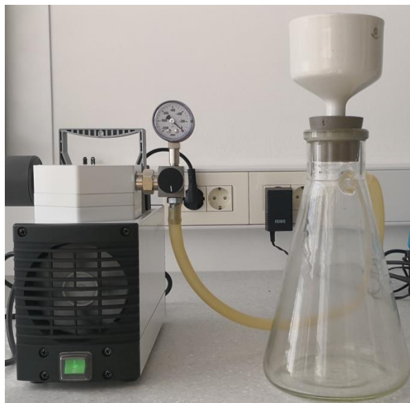
Slika 2.1 Aparatura za vakuum filtraciju.
