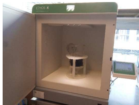
Slika 9. Postavljanje uzorka u mikrovalnu peć
