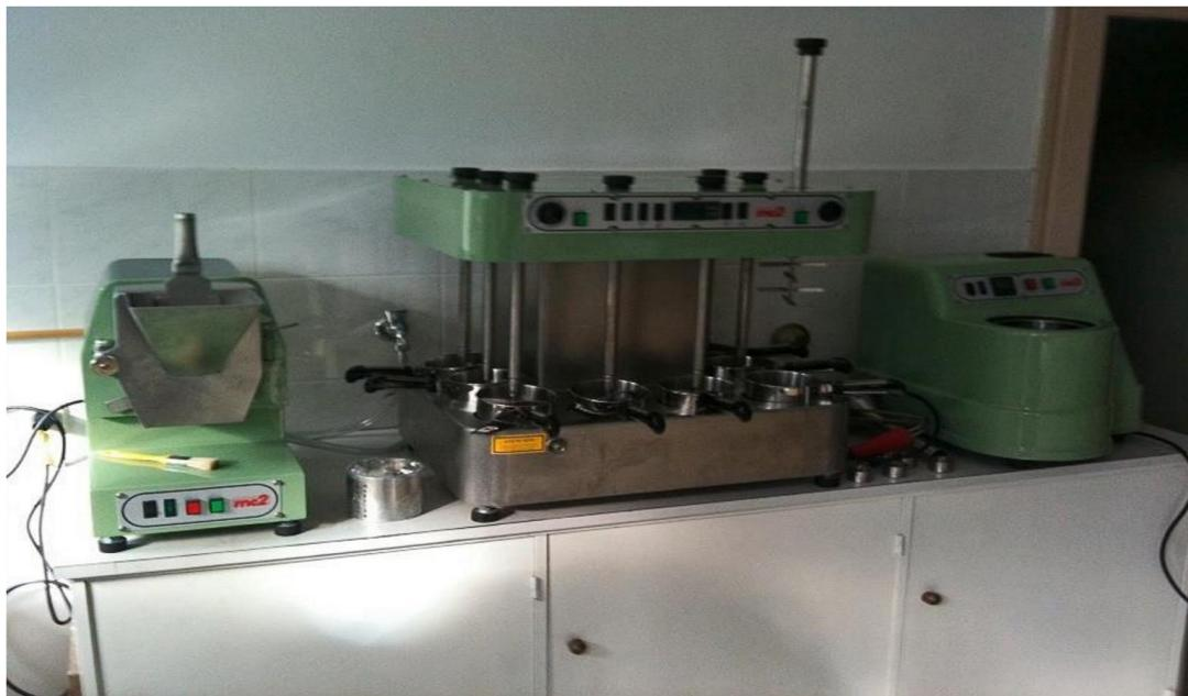
Slika 6. Mini laboratorijska uljara (Abencor mc2)
