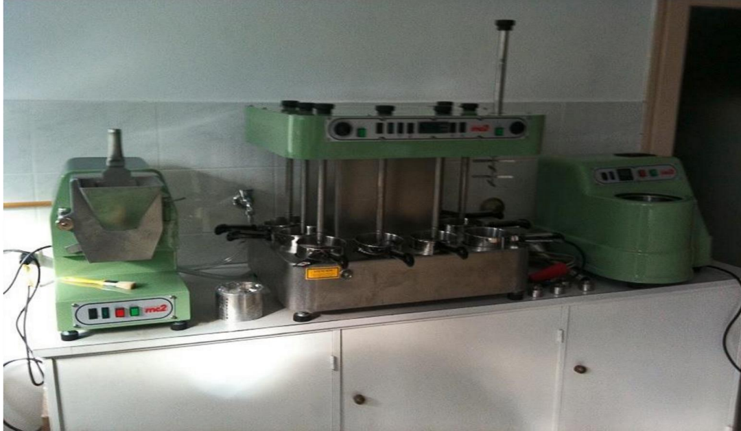
Slika 6. Mini laboratorijska uljara (Abencor mc2)
