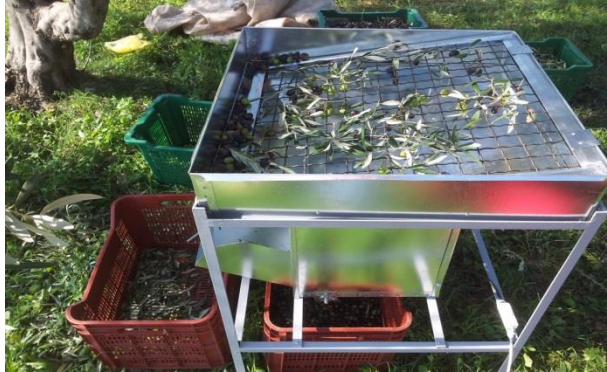
Slika 7. Stroj za odvajanje lišća od plodova masline 5
