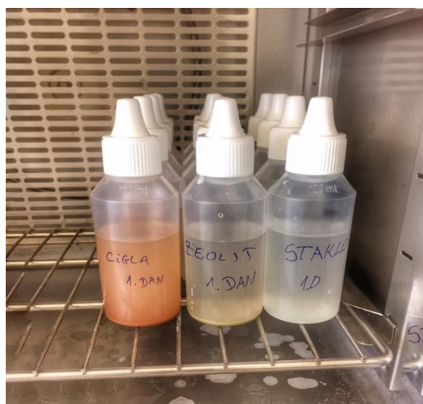
Slika 8. Termostatirani uzorci tijekom testa zasićenosti vapnom
