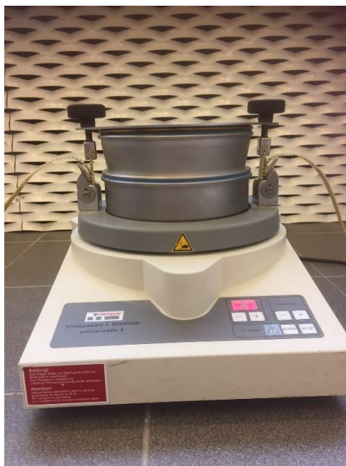
Slika 5. Laboratorijska treskalica sa sitom promjera čestica < 125 \mu\text{m}
