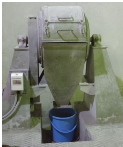
Slika 11. Prikaz poluindustrijskog horizontalnog mlina s čeličnim kuglama [12]
