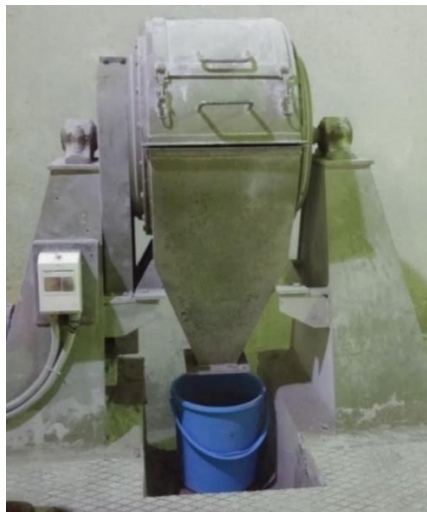
Slika 11. Prikaz poluindustrijskog horizontalnog mlina s čeličnim kuglama [12]
